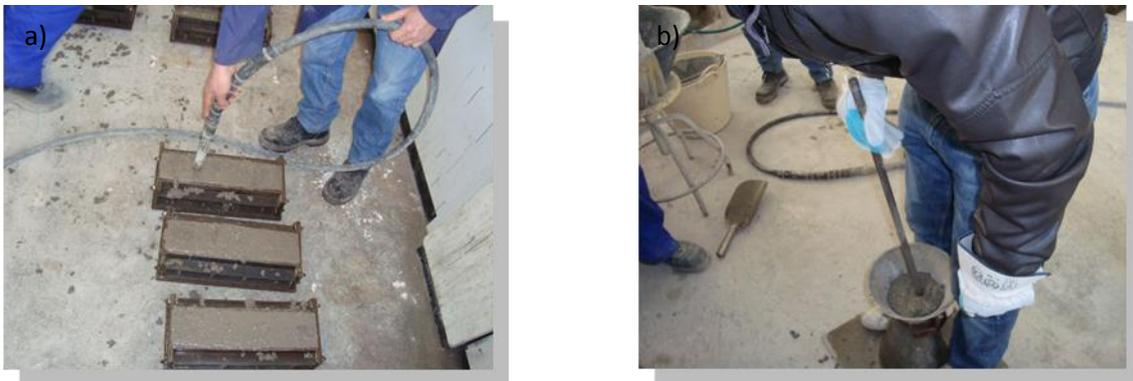
Figura 5.5. (a) Vibrado del hormigón. (b) Ensayo de cono Abrams.
