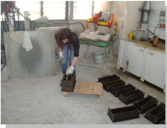
Figura 5.1. Aplicación de aceite a los moldes.
