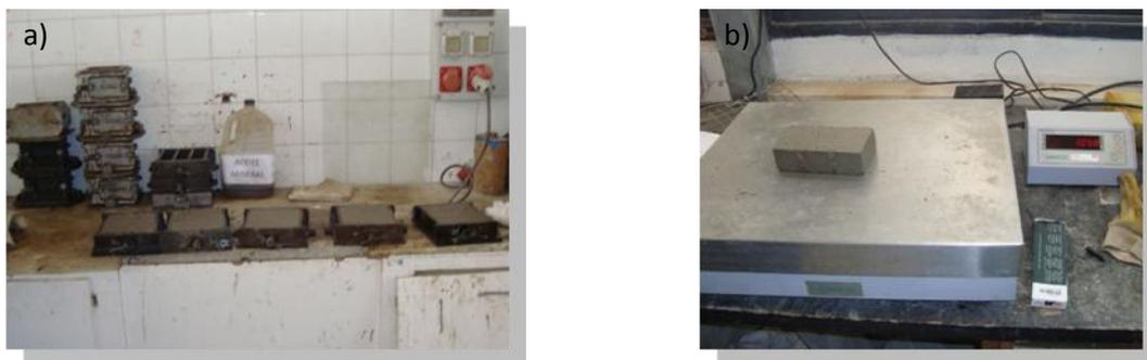
Figura 5.8. (a) Probetas ensayos compresión. (b) Pesado probetas para conocer su masa.
