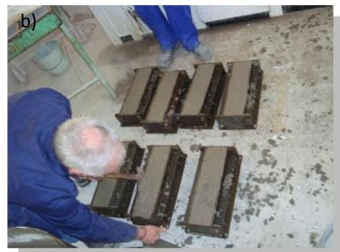
Figura 5.3. (a) Amasado del hormigón. (b) Vertido del hormigón en los moldes.
