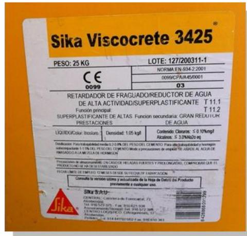
Figura 5.4. Aditivo utilizado para confección del hormigón.
