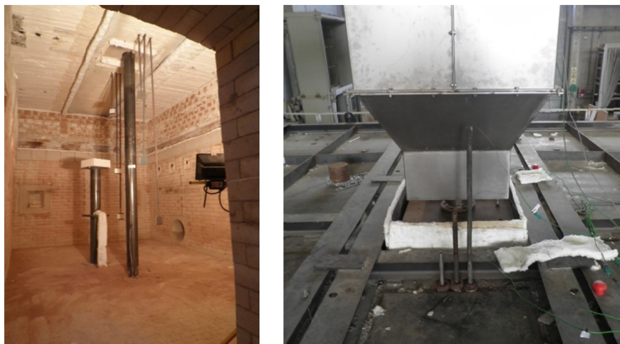
Figura 4.30. Disposición de un pilar en el horno antes del ensayo de resistencia al fuego con los 6 termómetros de placa y su homólogo no esbelto (izq.). Apoyo superior del pilar (se aprecian los tubos de salida de los termopares y los cajones de protección de la instrumentación del pórtico de carga y del apoyo) (der.)
