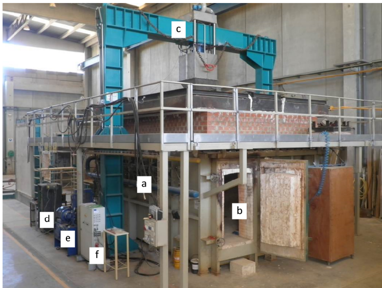
Figura 4.9. Vista general de las instalaciones de ensayo: a) horno horizontal; b) puerta de acceso a la cámara de combustión del horno; c) pórtico de carga; d) unidad de adquisición de datos de temperatura; e) grupo hidráulico; f) unidad de adquisición de datos de carga
