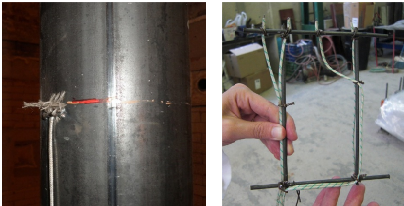
Figura 4.23. Posicionamiento del termopar superficial TC1 (izq.) y bastidor de fijación de los termopares internos TC2 a TC 5 (der.)
