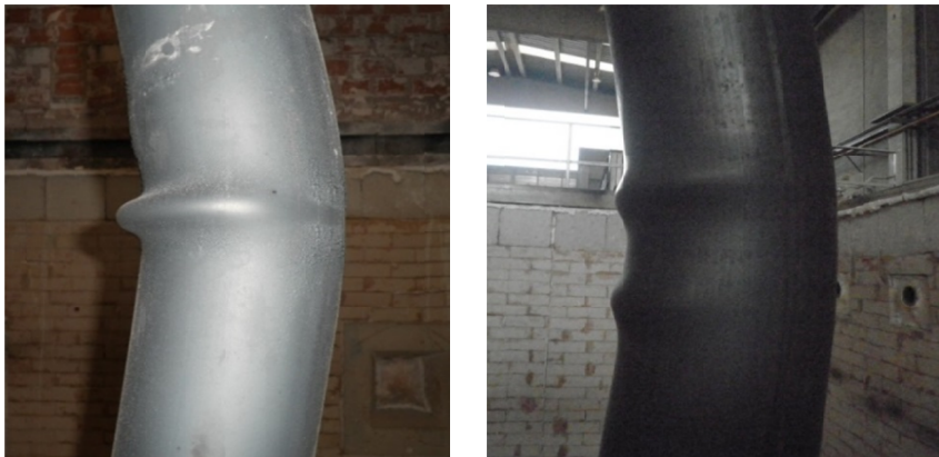
Figura 4.34. Pandeo local a media altura del perfil tubular
