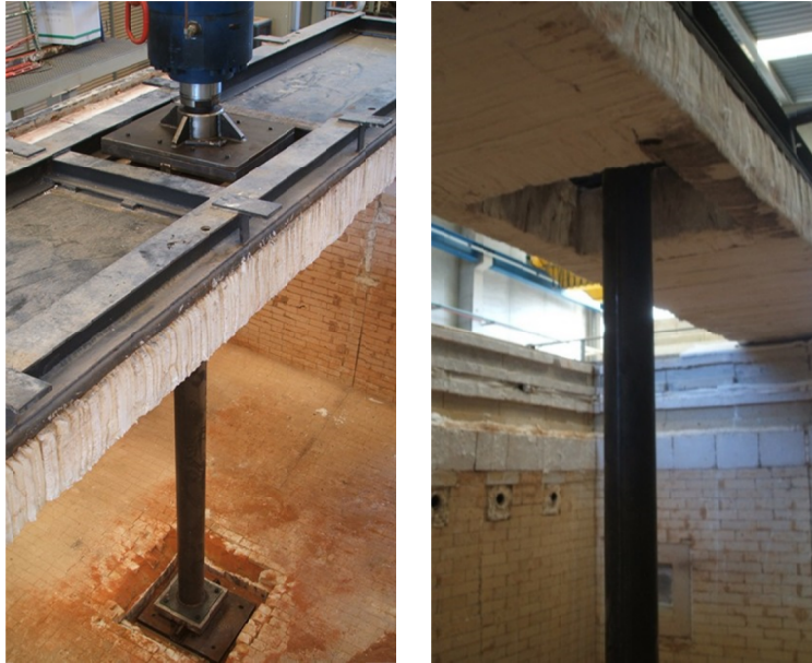
Figura 4.29. Fase intermedia de la instalación de un pilar en el interior del horno
