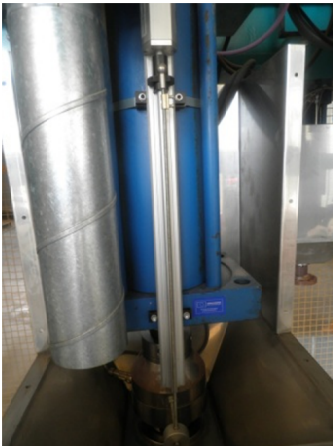
Figura 4.15. Captador de desplazamiento y detalle del alojamiento de su extremo móvil
