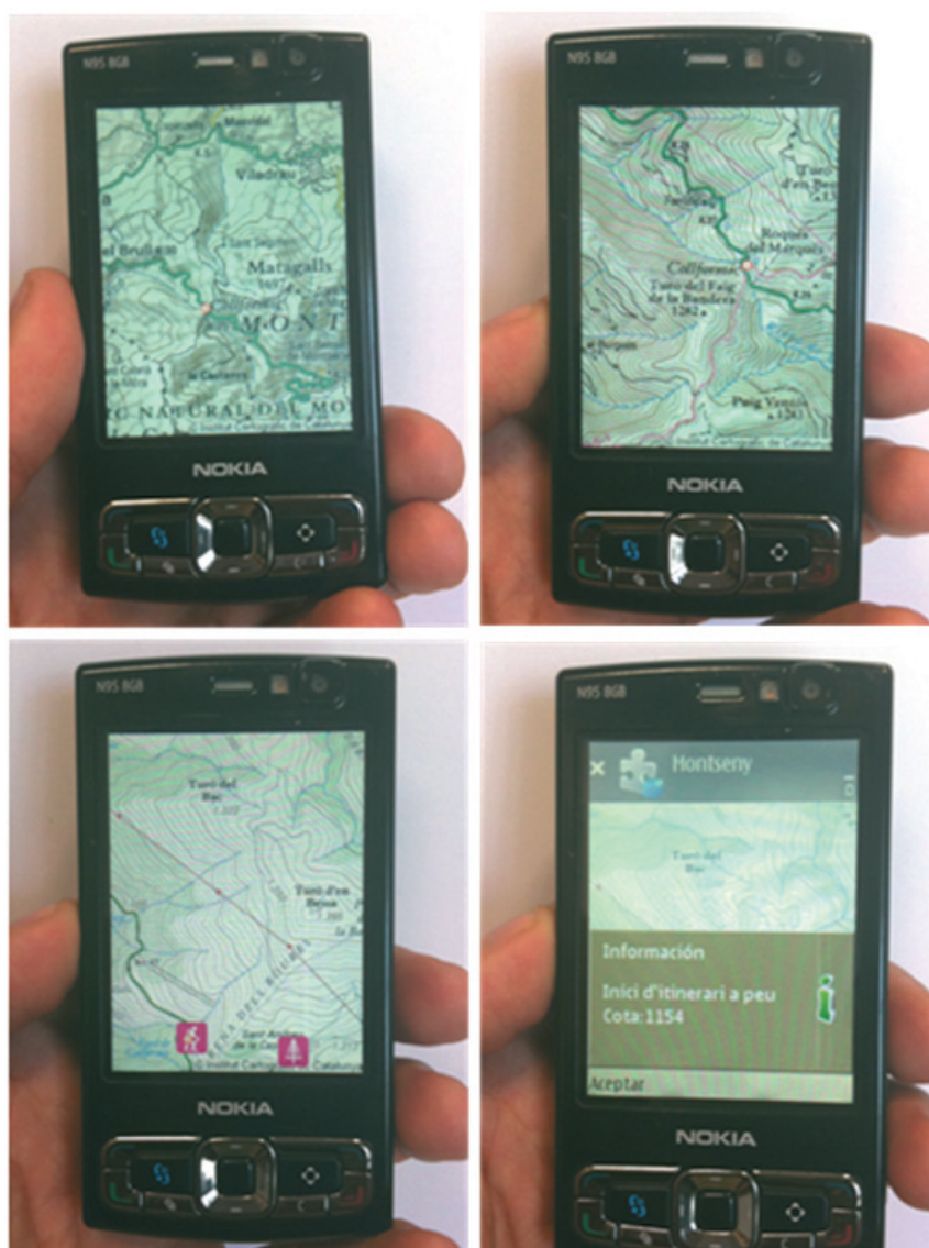
Figura 7. Mapa base a escala 1:200.000 (superior izquierda); mapa base a escala 1:50.000 (superior derecha); mapa base a escala 1:25.000 e iconos añadidos (inferior izquierda); resultado de una consulta sobre el mapa de atributos (inferior derecha).
