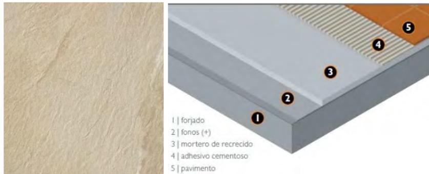
Debajo del pavimento cerámico fijado con adhesivo cementoso y colocado sobre mortero de recrecido, se dispone una lámina para la transmisión de ruido por impacto entre viviendas.
