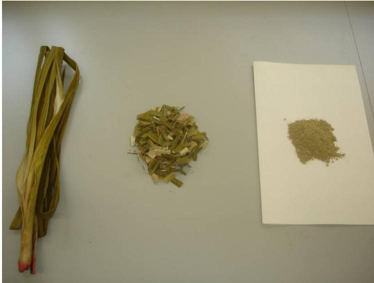
**Figura 40:** A la izquierda la muestra desecada después de salir de la estufa; en el centro la muestra troceada lista para ser introducida en el molinillo; a la derecha muestra triturada y convertida en polvo.
