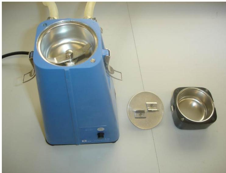
**Figura 39: Molinillo utilizado para triturar las muestras vegetales. A la izquierda se pueden ver las aspas metálicas en el interior del molinillo; en el centro la tapa con las cuchillas; a la derecha tapa del molinillo.**
