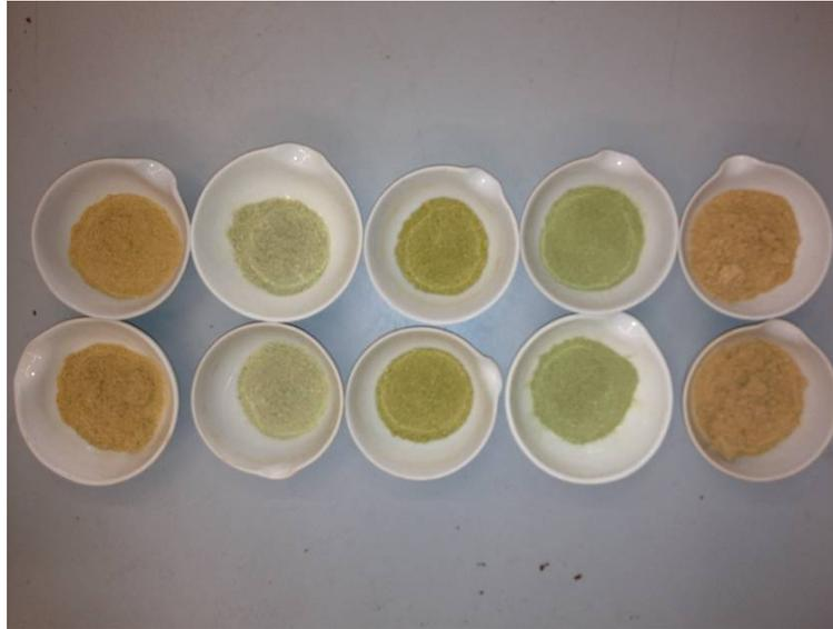
**Figura 48: Muestras molidas y colocadas en cápsulas de porcelana, para ser introducidas en la mufla.**
