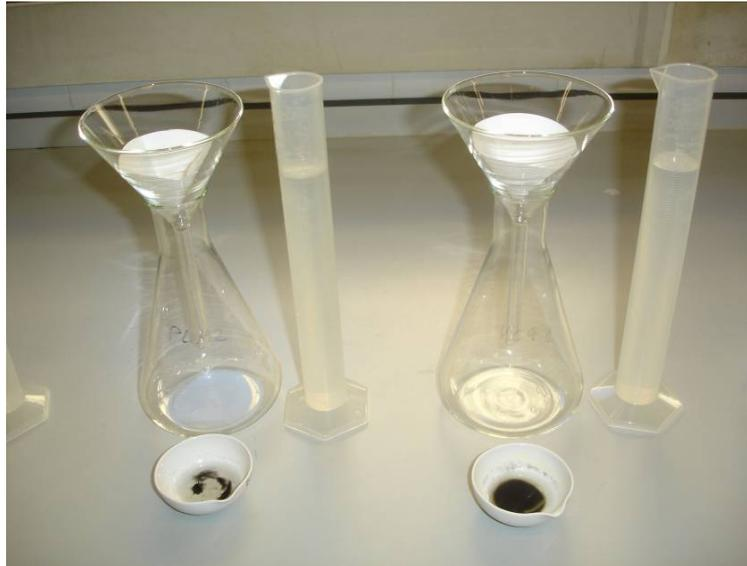
**Figura 51: Muestras a punto de ser filtradas. Se observa el material empleado, la probeta con 100 ml de agua desionizada, el filtro de papel en el embudo de vidrio, el matraz Erlenmeyer donde se recoge el líquido filtrado y la cápsula con la muestra calcinada.**
