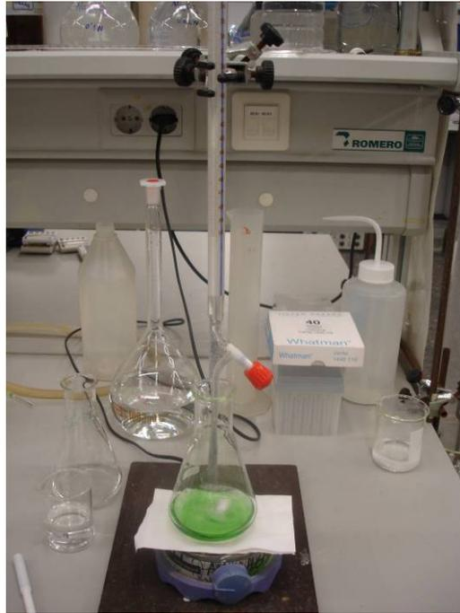
Figura 46: Bureta con ácido sulfúrico 0,02 N, preparada para valorar el producto de la destilación con las tres gotas del indicador añadido.
