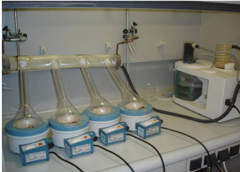
**Figura 43: Digestión de las muestras en las mantas calefactoras. Cabe destacar el captador de vapores corrosivos y el bombeo de los mismos hasta el purificador de aire a la derecha de la figura.**
