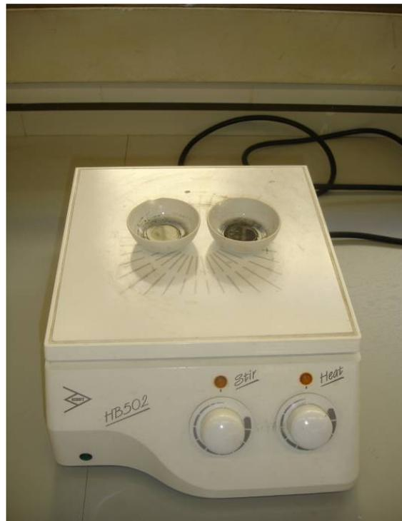
Figura 50: Muestras calentándose en la placa calefactora con agitador.
