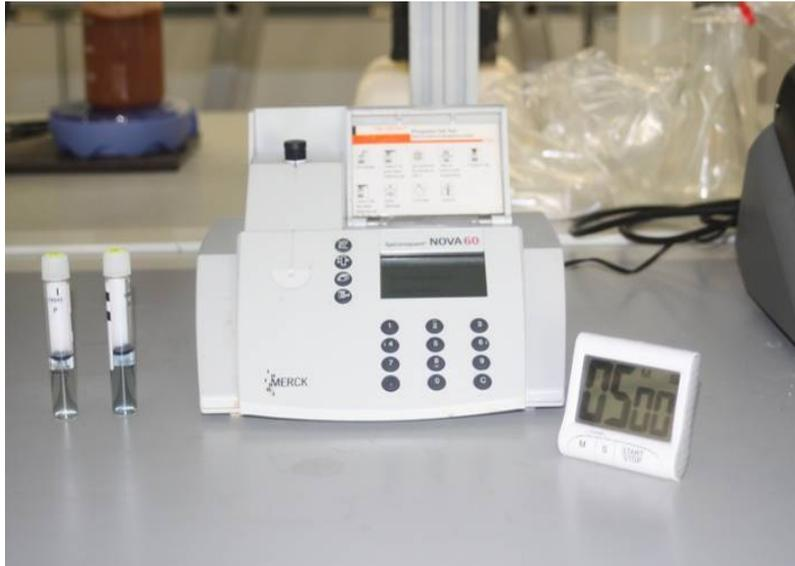
Figura 52: Fotómetro utilizado para la determinación de los orto-fosfatos contenidos en el material vegetal, se pueden observar los tubos de ensayo con la coloración ligeramente azulada (azul de fosfomolibdeno).
