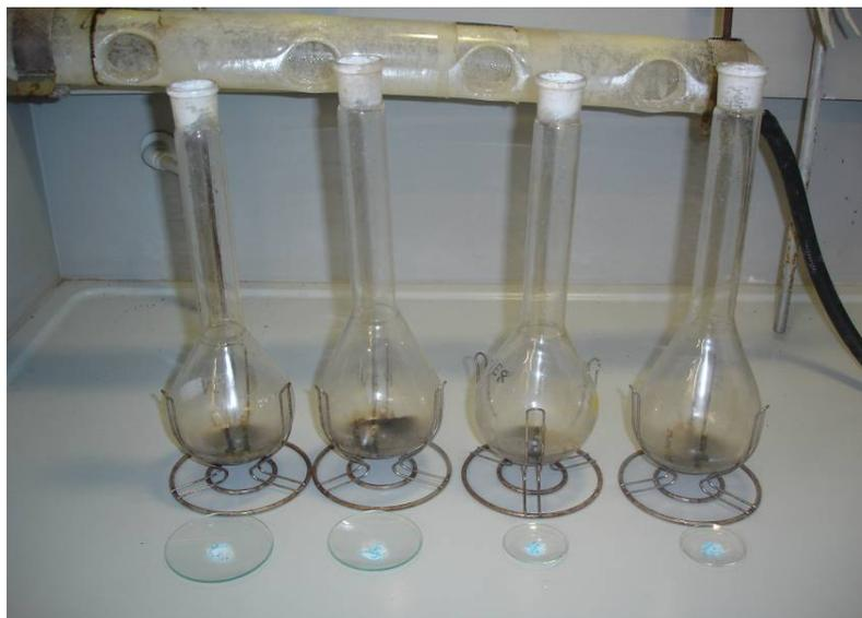
Figura 42: Matrazes de cuello largo con la muestra en contacto con el ácido sulfúrico concentrado. A los pies de los matrazes se pueden ver cuatro vidrios de reloj con el catalizador.
