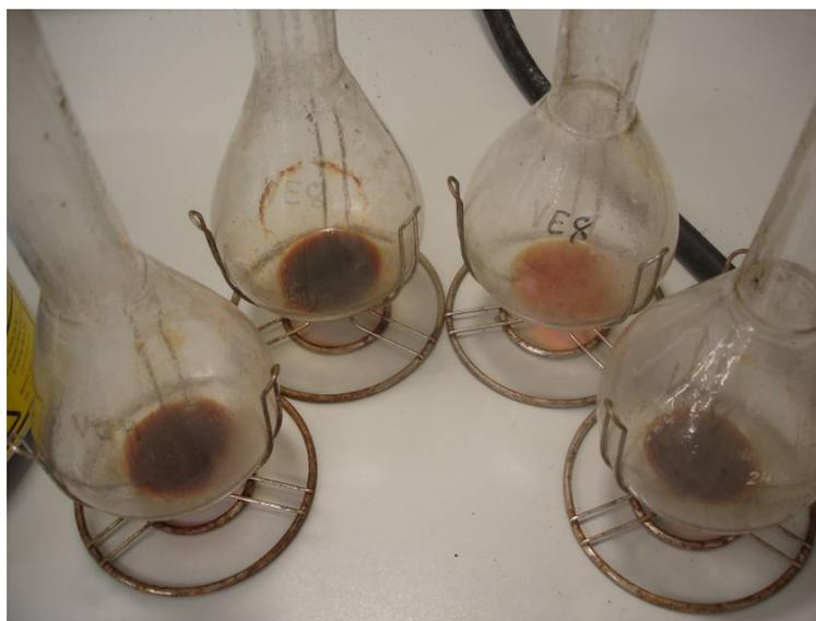
**Figura 44: Matraces enfriándose tras la digestión con el ácido sulfúrico y el catalizador.**
