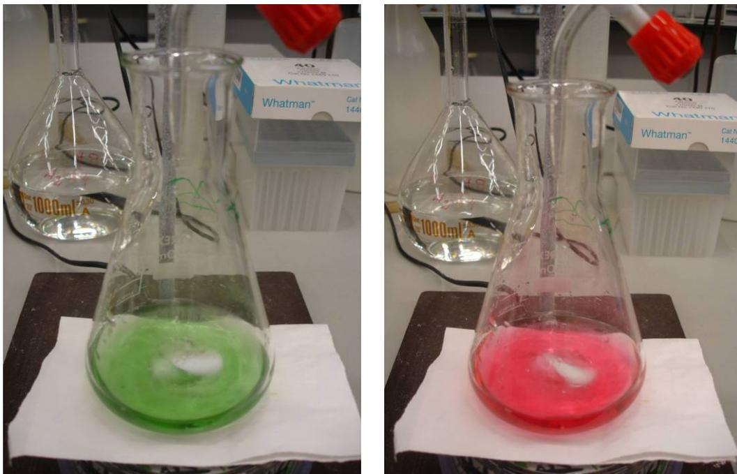
Figura 47: Viraje tras la valoración con ácido sulfúrico 0,02 N. De color verde cambia a rosa-rojo.
