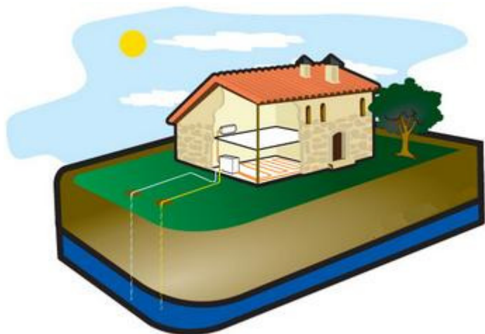
Figura 17. Sistema vertical de aguas subterráneas
