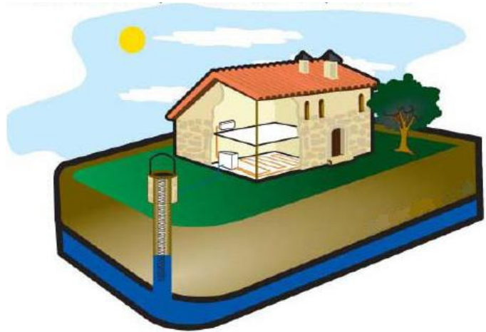
Figura 18. Sistema vertical de pozo existente
