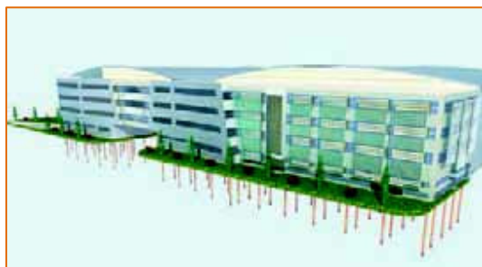
Figura 24. Edificio con estructura de pilotes
