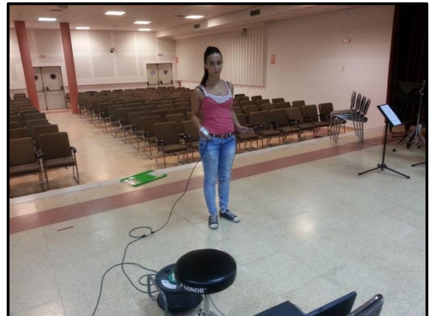
Figura 8. Ensayo de medición de tiempo de reverberación.
