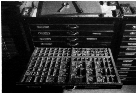
Figura 41. Disposición de los tipos de caja alta y caja baja en un chibalete.
