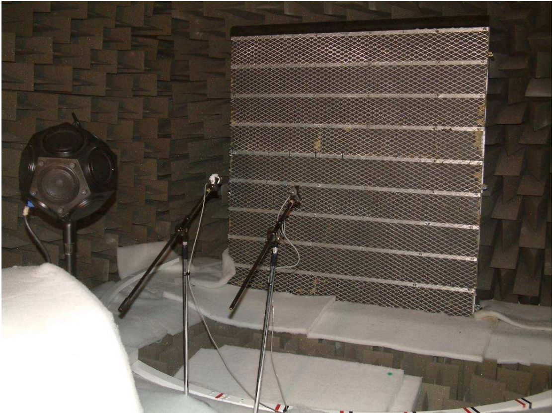
Figura.6. Barrera P3: Panel de rejilla con lana mineral en el interior. Profundidad= 7,5 cm
