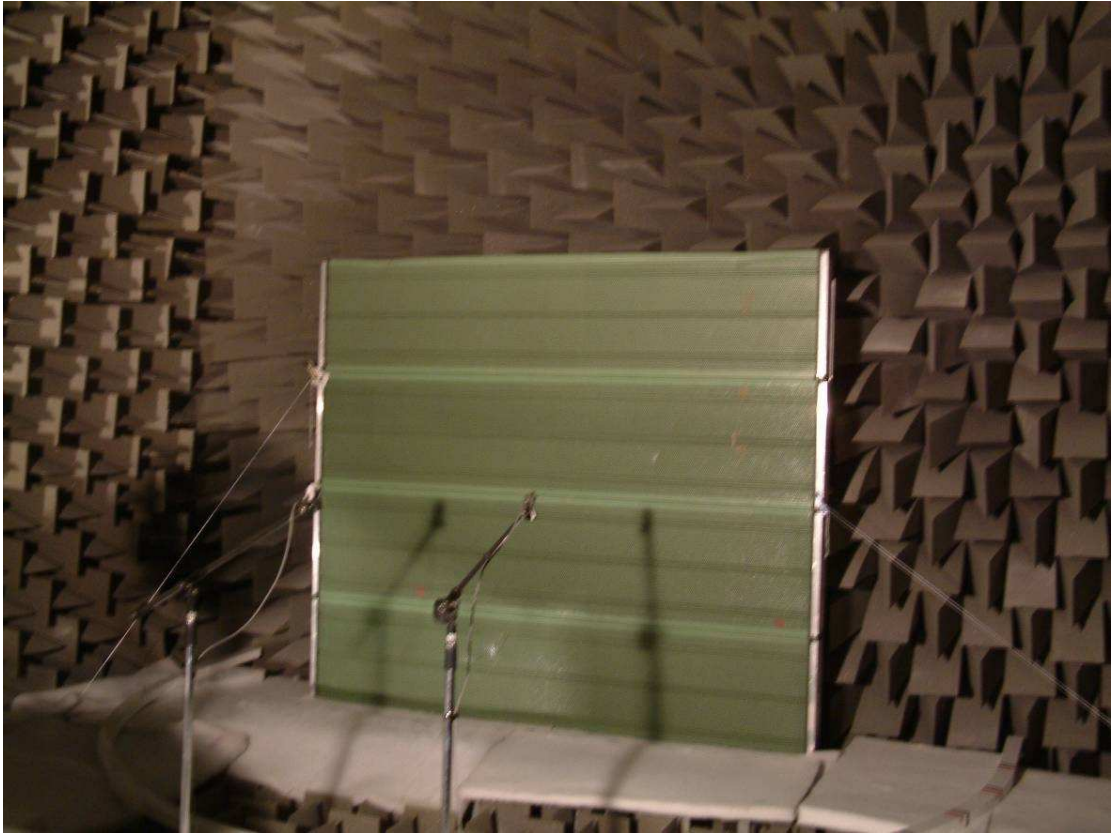
Figura.5. Barrera P2: Panel verde perforado. Profundidad= 13+7 cm
