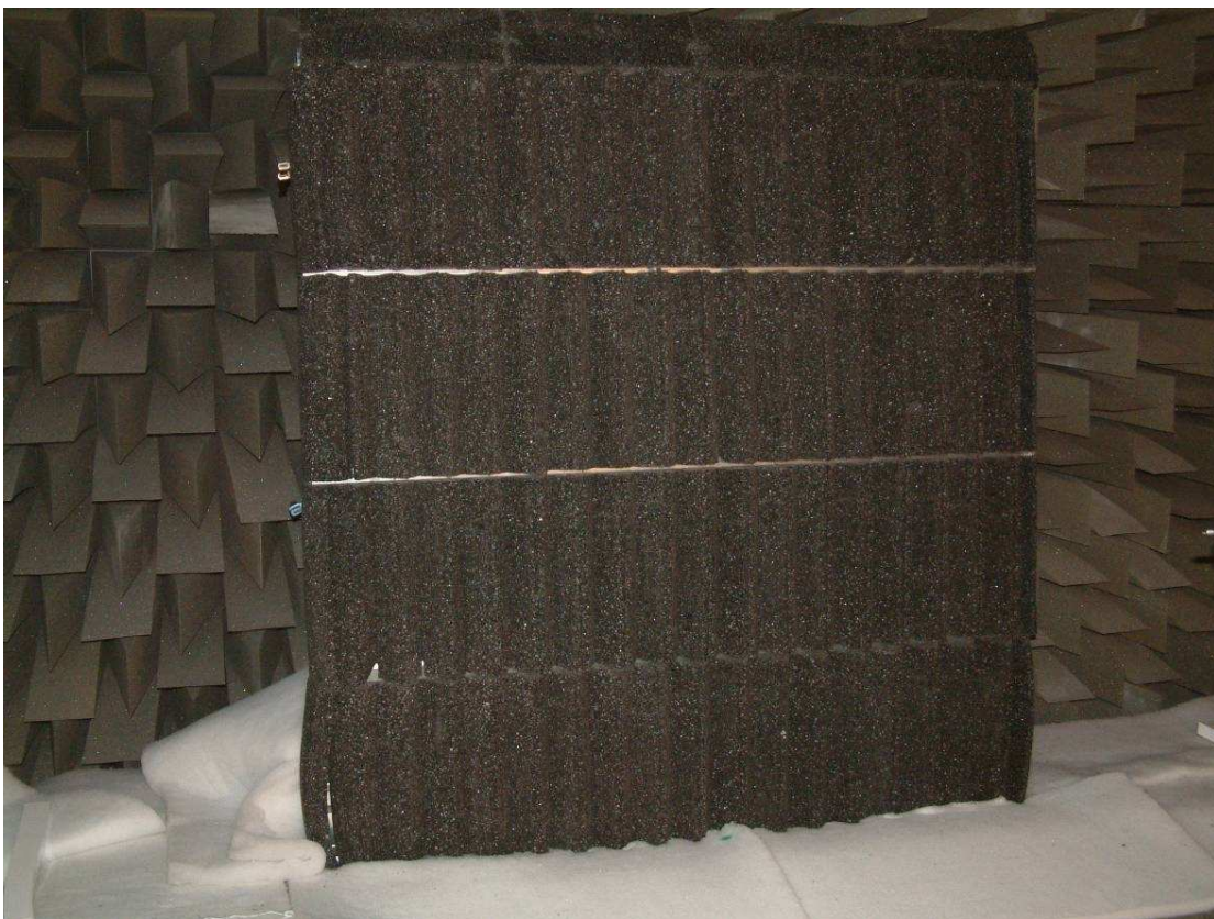
Figura.8. Barrera P5: Con material reciclado en forma de Zig-Zag. Width = 13 + 7 (cm)
