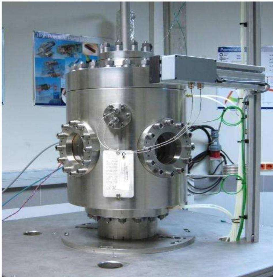
**Figura 2.10** - Cámara de combustión de la instalación de alta presión y temperatura
