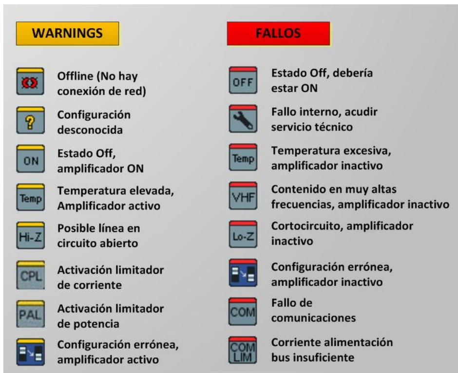
Figura 6.22. Indicadores de avisos y fallos del sistema
