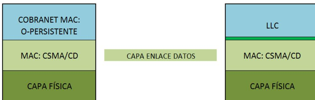
Figura 2.8. Modelo de capas de Cobranet – Ethernet
