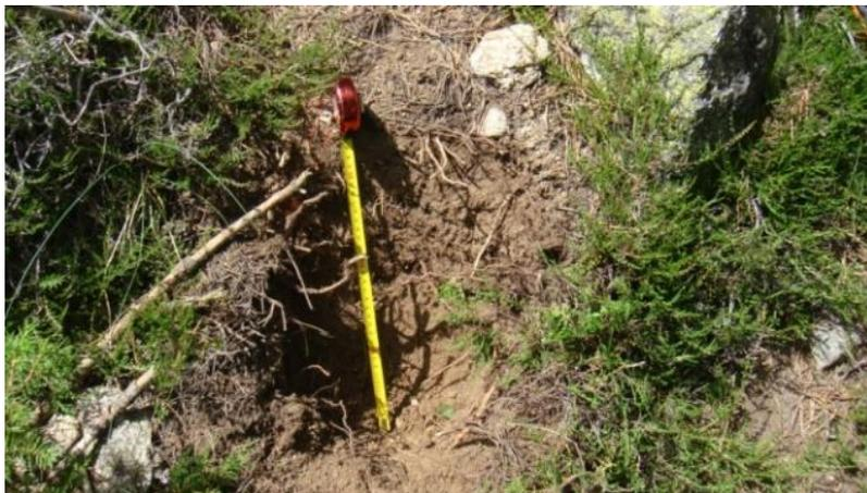
Figura 6. 29. Cata 14, realizada entre 25 y 30 cm, no se observó cambio en el perfil del suelo y se encontró roca.
