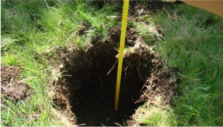
Figura 6. 13. Cata 6, realizada a 35 cm de profundidad, no se observó cambio en el perfil del suelo y se encontró roca.
