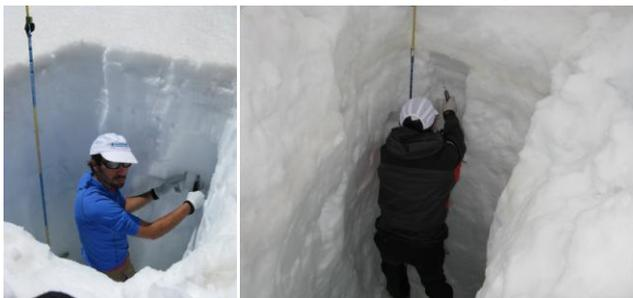
Figura 4. 28. Extracción de muestras para obtener la densidad del manto de nieve.
