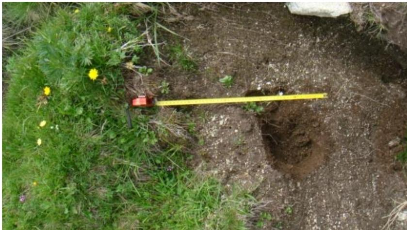
Figura 6. 23. Cata 11, realizada entre 40 y 45 cm, no se observó cambio en el perfil del suelo y se encontró roca.
