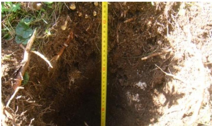
Figura 6. 3. Cata 1, realizada entre 35 y 45 cm, a esta profundidad no se observó cambio en el perfil del suelo. El suelo completamente cubierto por vegetación.
