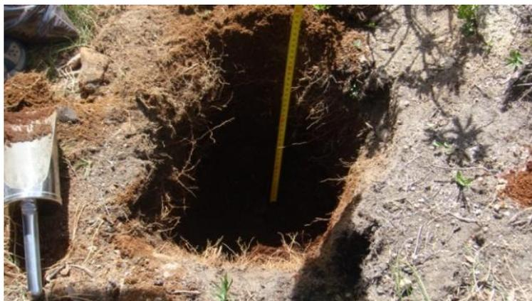
Figura 6. 11. Cata 5, realizada a 30 cm de profundidad, no se observó cambio en el perfil del suelo y se encontró roca.
