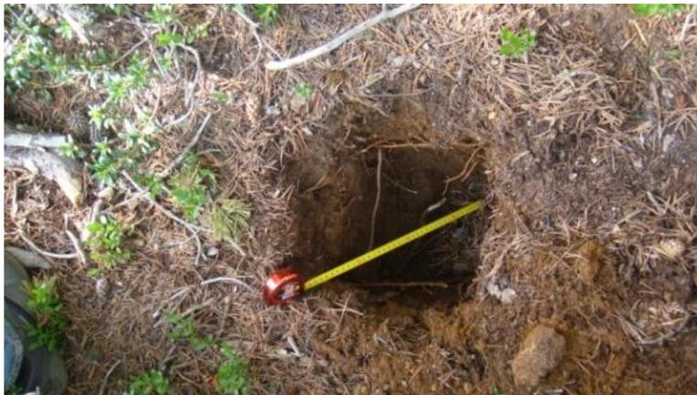
Figura 6. 17. Cata 8, realizada entre 35 y 40 cm de profundidad, no se observó cambio en el perfil del suelo y se encontró roca.
