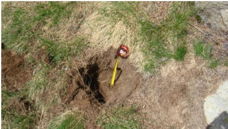
Figura 6. 19. Cata 9, realizada entre 15 y 20 cm de profundidad, no se observó cambio en el perfil del suelo y se encontró roca.
