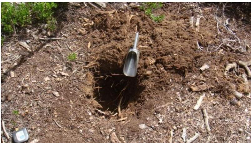
Figura 6. 15. Cata 7, realizada a 25 cm de profundidad, no se observó cambio en el perfil del suelo y no se encontró roca.
