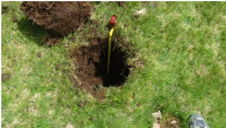
Figura 6. 21. Cata 10, realizada entre 30 y 35 cm, el perfil cambia a partir de los 35 cm de profundidad (arena), y no se encontró roca.
