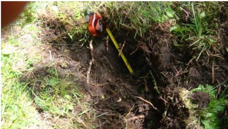
Figura 6. 27. Cata 13, realizada a 25 cm de profundidad, no se observó cambio en el perfil del suelo y no se encontró roca.
