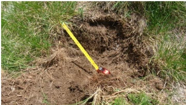
Figura 6. 5. Cata 2, realizada a 20 cm de profundidad, no se observó cambio en el perfil del suelo y se encontró roca.
