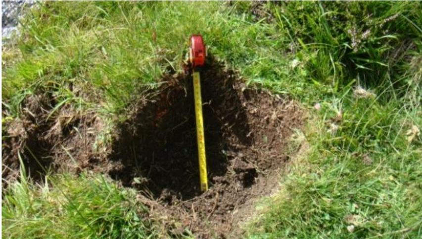
Figura 6. 31. Cata 15, realizada a 15 cm de profundidad, no se observó cambio en el perfil del suelo y se encontró roca.
