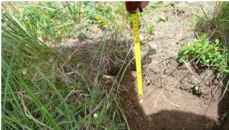
Figura 6. 25. Cata 12, realizada a 10 cm de profundidad, no se observó cambio en el perfil del suelo y se encontró roca.
