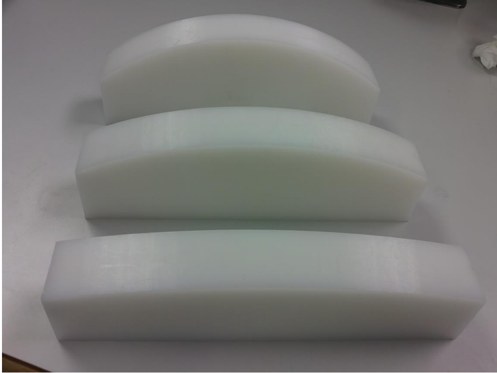
Figura 4.4. Moldes utilizados en la calibración. De arriba a abajo los radios de curvatura son 114.59, 171.89 y 343.77 mm respectivamente.
