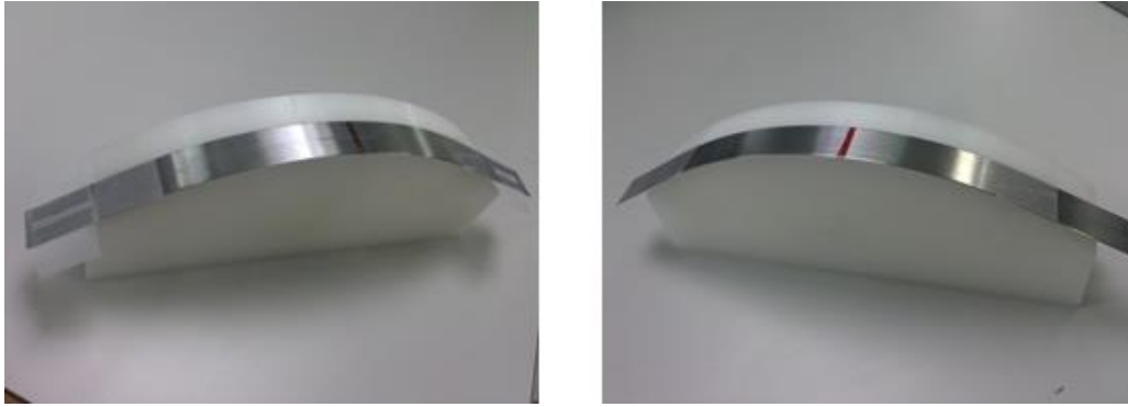
Figura 4.2. Molde utilizado para la precompresión de la fibra. A la izquierda el fleje 1 y a la derecha el fleje 2.
