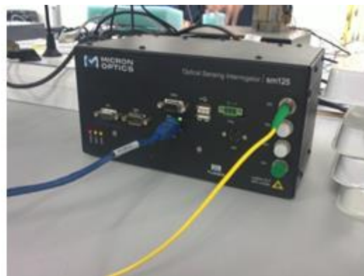
Figura 4.5. Sistema de interrogación utilizado. A la izquierda, ordenador portátil con software Enlight . A la derecha el interrogador Micron Optics sm125
