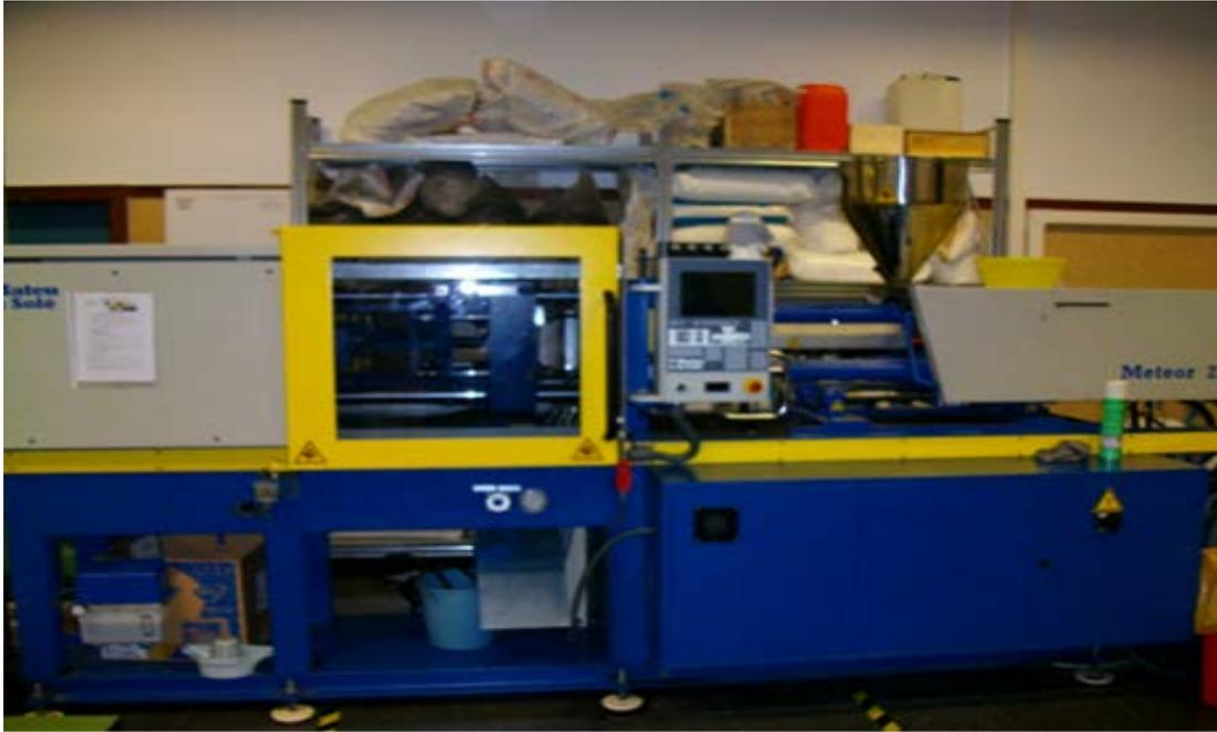
Figura 7. Inyectora del departamento de ingeniería mecánica y de materiales. Fuente: Elaboración propia.
