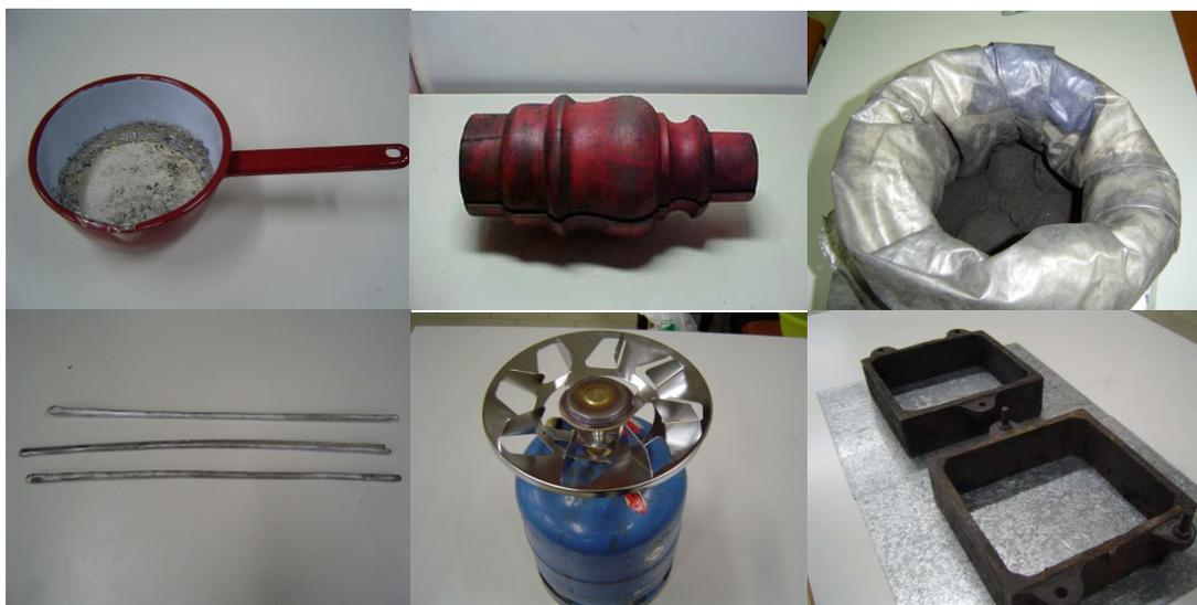
Figura 1. Cazo, modelo, arena, estaño, hornillo, caja de moldeo. Fuente: Elaboración propia.
