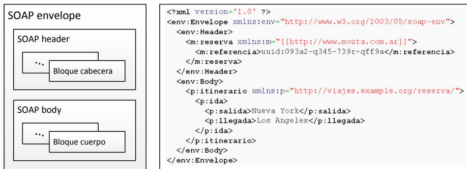
Figura 12: Esquema y ejemplo de mensaje SOAP.
