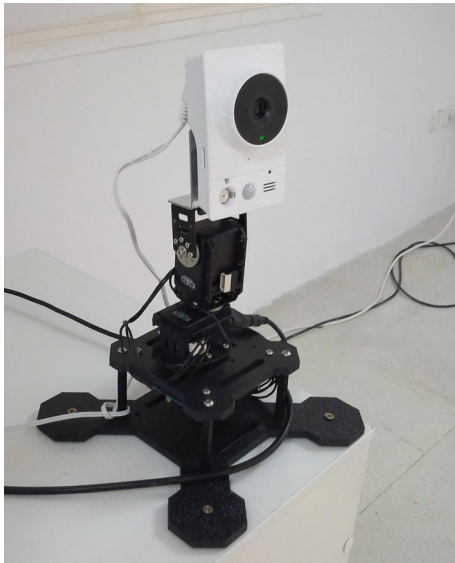
Fig. 38. Torreta WidowX con la cámara D-Link instalada.
