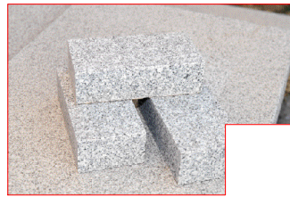
2_Pavimento de adoquín de granito abujardado con junta trabada
