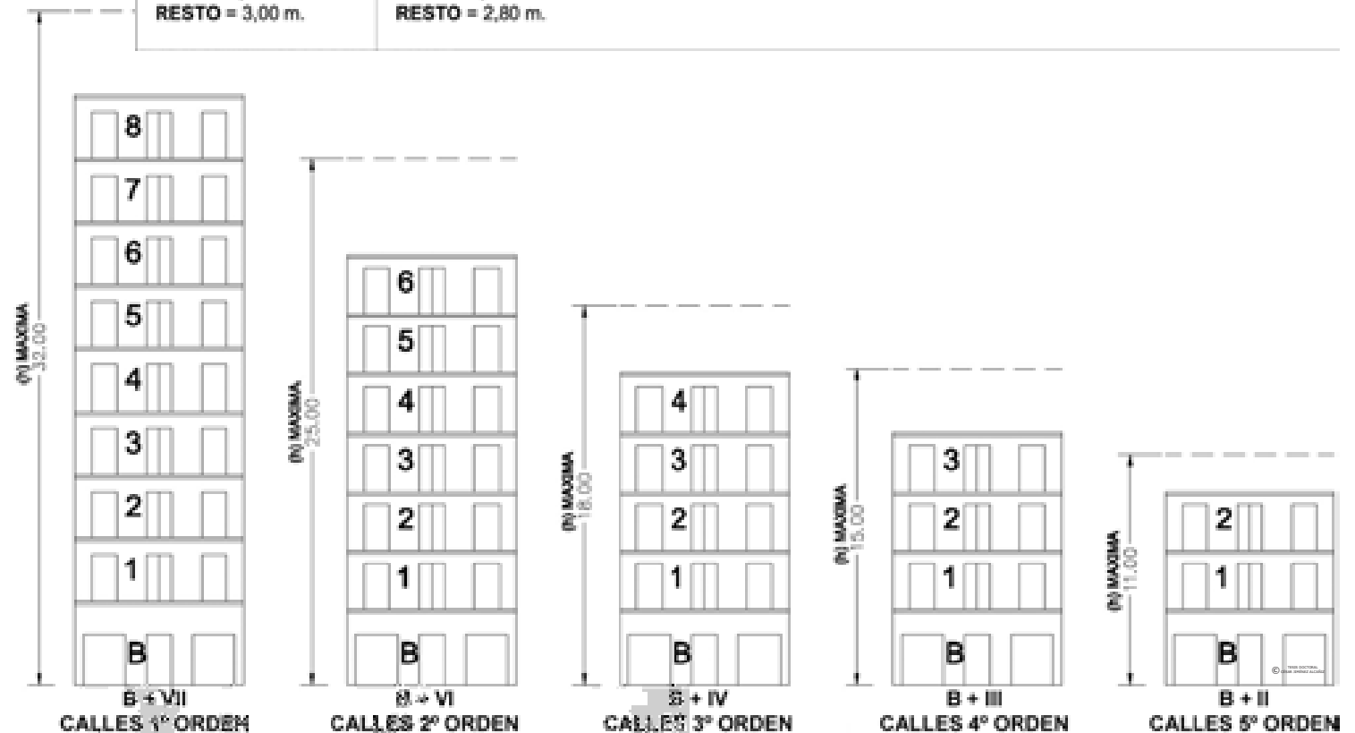
Fig.97. Altura de cornisa máxima, y número de plantas permitidas, en función de la clasificación de la calle en la que se encuentra la edificación en el Bloque Normativo IV.
