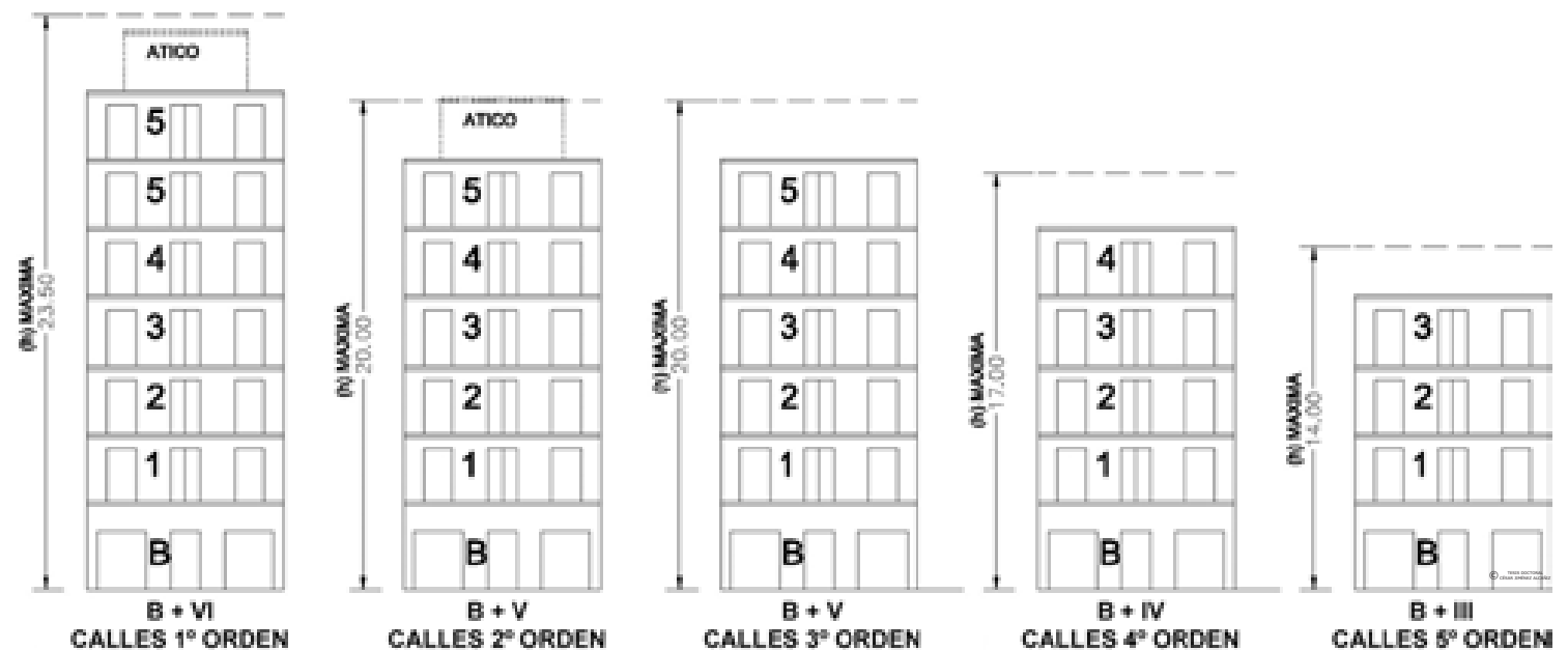
Fig.107. Altura de cornisa máxima, y número de plantas permitidas, en función de la clasificación de la calle en la que se encuentra la edificación en el Bloque Normativo V.
