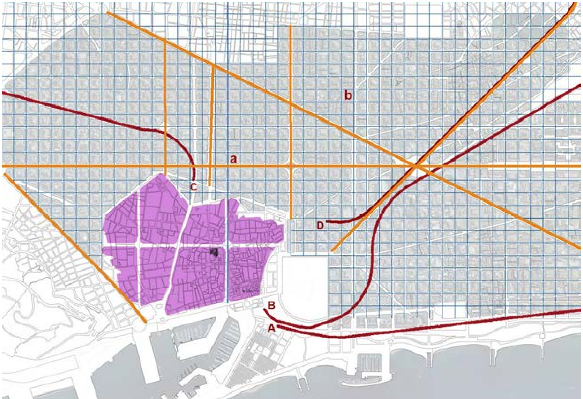
Fig.108. Esquema del replanteo del Ensanche de Barcelona. a Intersección Via Laietana y Gran Via. b La Sagrada Familia. Lineas naranja , ejes principales configuradores del trazado. A,B,C y D , estaciones del ferrocarril y tendido. Fuente: Elaboración propia, sobre plano del Centre de Cultura Contemporània de Barcelona (CCCB)
