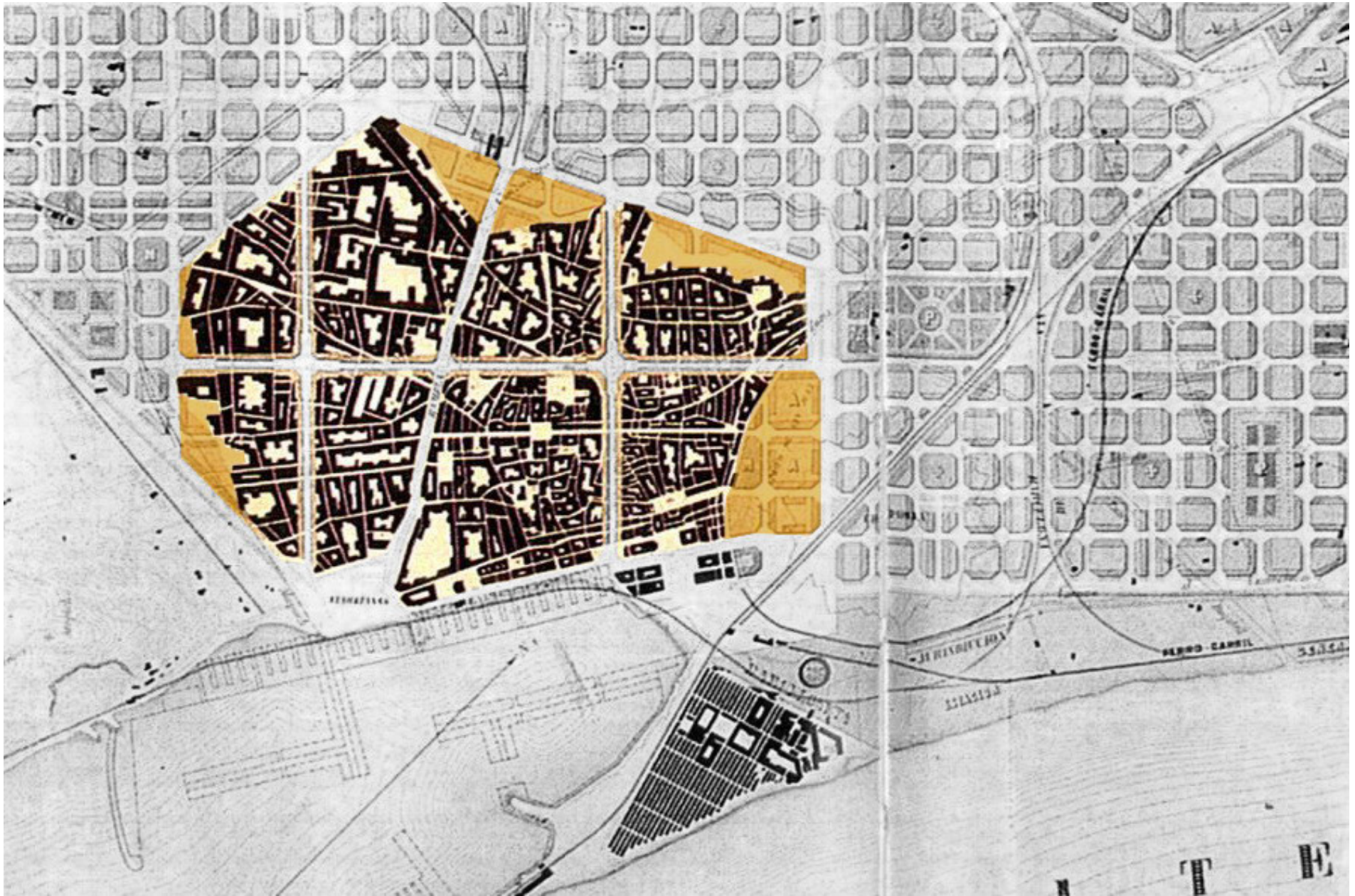
Fig.115. Integración de la ciudad histórica con el Ensanche de Barcelona mediante la apertura de nuevos ejes viarios. Fuente: Elaboración propia sobre el Proyecto de Reforma y Ensanche de Barcelona de Ildefonso Cerdá.
