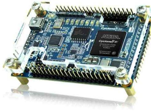
Figura 15. Imagen exterior de una FPGA.
