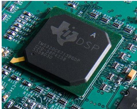
**Figura 17. Imagen exterior de un DSP.**
