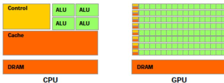
Figura 22. Diferencia de transistores entre GPU's y CPU's.
