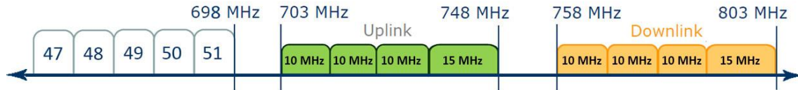
Figura 90. Primer caso de interferencia LTE: 3 bloques de 10 MHz + 1 bloque de 15MHz.
