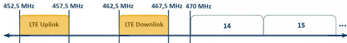
Figura 14. Canalización LTE para Colombia en 450 MHz vs. Canales 14 y 15 DVB-T2. Banda de guarda entre tecnologías de 2,5 MHz.
