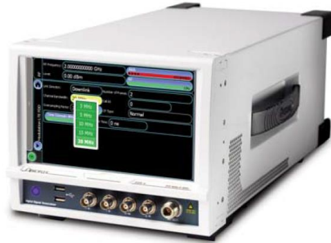
Figura 63. Aeroflex SGD utilizado para generar señales LTE.
