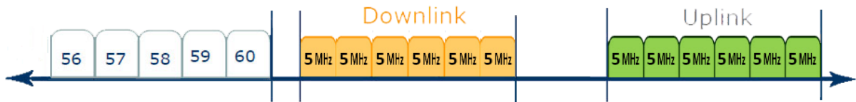
Figura 87. Segundo caso de interferencia LTE: 6 bloques de 5 MHz.
