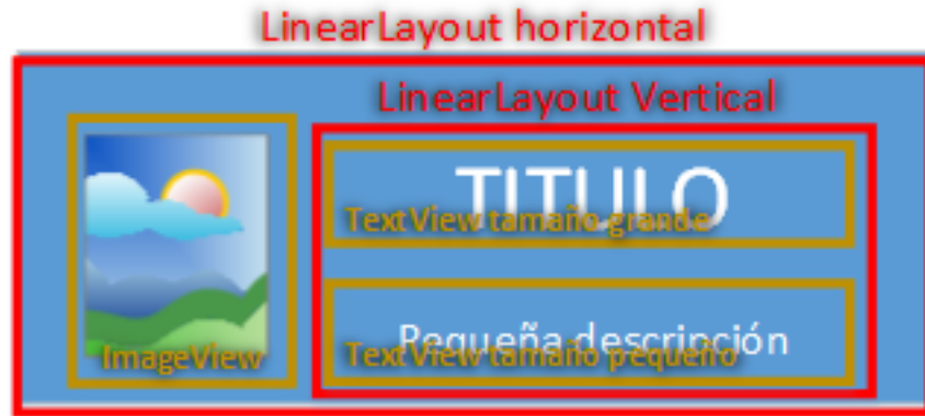
Figura 4.6 Estructura de una entrada
