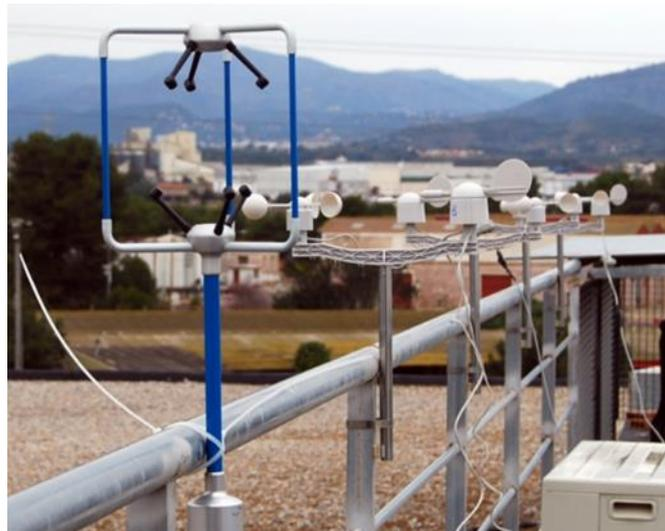
Figura 10 Calibración de los sensores de cazoleta y veleta frente al sensor sónico
