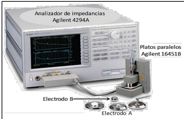
Figura 3.2.4 Analizador de impedancias Agilent 4294A y platos paralelos Agilent 16451B.
