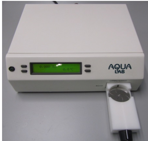
Figura 3.3.2 Equipo para medir la actividad de agua ( a_w ).
