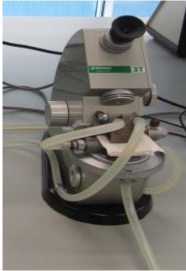
Figura 3.3.3 Refractómetro ABBE ATAGO, 3-T.
