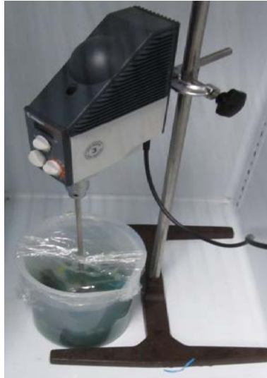
Figura 3.6.2 Detalle de la operación de la cinética de salado en cámara refrigerada a 4°C.
