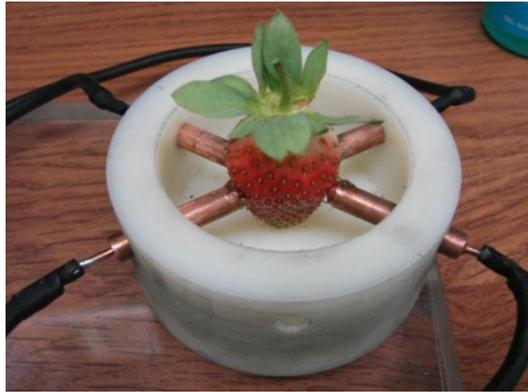
Figura 4-11. Posición de la fresa durante el ensayo de medición de la impedancia bio - eléctrica.
