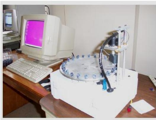
Figura A-3. Detalle del equipo “*FirmTech II*” para medir la firmeza de frutos pequeños. [www.bio-works.us](http://www.bio-works.us)
