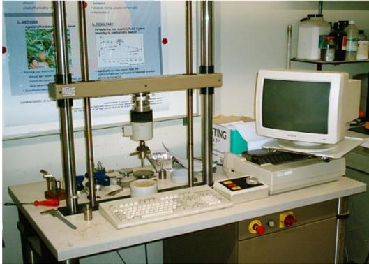
Figura 2-26. Máquina Universal de Pruebas (UTM, por sus siglas en inglés). Departamento de Maquinaria Agrícola y Procesos de la Universidad Católica de Leuven, Bélgica.
