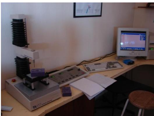
Figura 2-27. Texturómetro TA-XT2 marca Stable Micro Systems. Departamento de Ciencias de la Vida Campus Irapuato – Salamanca, Universidad de Guanajuato.
