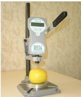
Figura 2-28. Equipo PENECEL DFT 14 para medir la firmeza de manera no destructiva. [www.infoagro.com](http://www.infoagro.com).
