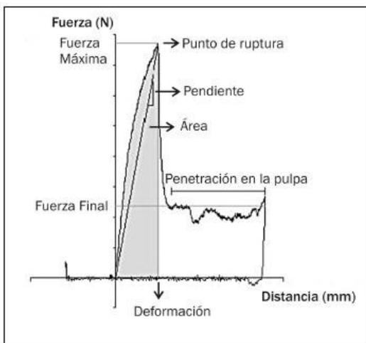
Figura 4-18. Gráfica típica de una prueba de fuerza - deformación.
