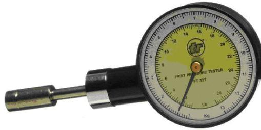
Figura 2-24. Penetrómetro modelo F.T.327, marca Effegi. Spectrum International.
