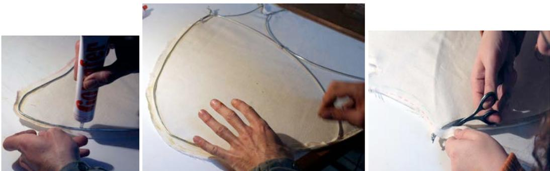
**Fig. 51,52y53:** cierre del forro y recortes de precisión
