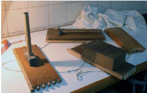
**Fig.50:** fijación del alambre a la tela con contrapesos
