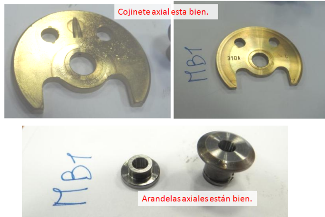
Figura 4.65. Fotografías cojinete axial y arandelas turbocompresor MIT-TD02-FRB (1) sin álabe.
