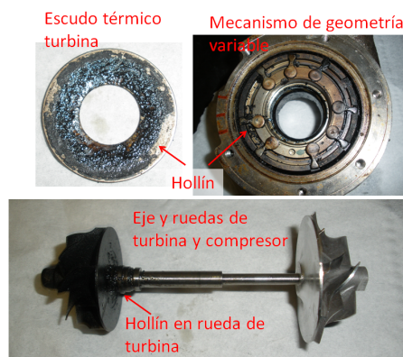
Figura 4.72. Fotografías turbocompresor BW-BV39-FRB, exceso de hollín.
