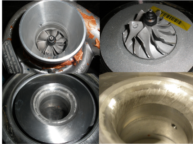
Figura 4.24. Fotografías rueda del compresor y carcasa del compresor BW-GTA17-SFRB(3), ensayo retraso en la lubricación.
