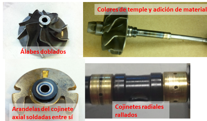
Figura 4.15. Fotos turbocompresor BW-BV39-FRB (1), ensayos a baja presión alto ratio de aceleración.
