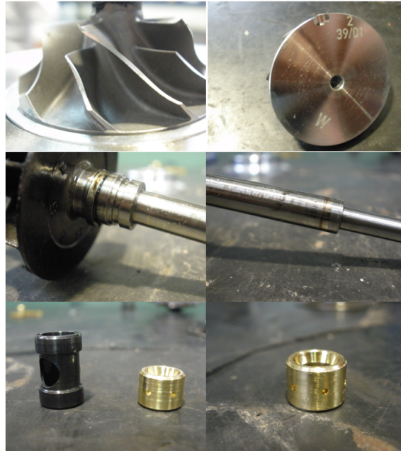
Figura 4.35. Fotografías de partes del tercer turbocompresor BW-KP35-FRB, ensayo interrupción de lubricación.
