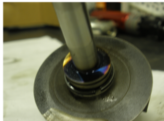
Figura 4.11. Fotografía eje con colores de temple turbocompresor BW-GTA17-SFRB (1), ensayo baja presión de aceite con ratio de aceleración bajo.
