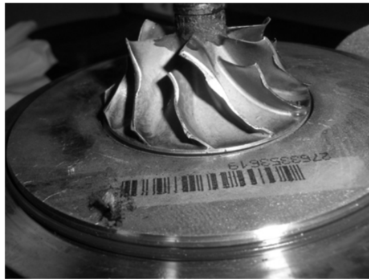
Figura 4.52. Rueda averiada de compresor para prueba de compresión.
