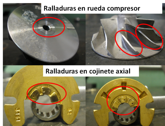
Figura 4.32. Fotografías de la rueda del compresor y cojinete axial segundo turbo-compresor BW-KP35-FRB, ensayo interrupción de lubricación.
