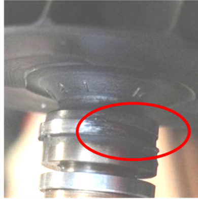
Figura 4.62. Fotografía anillo fundido en eje turbocompresor MIT-TD02-FRB.
