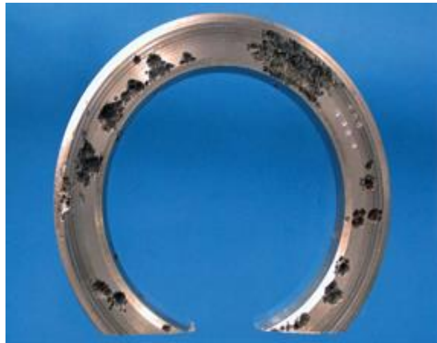
Foto 18: Corrosión por picaduras
