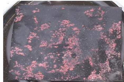
Foto 6: Plancha de cobre metálico recalentada hasta 300°C al aire. El oscurecimiento de la superficie se debe a la formación de los óxidos cuproso y cúprico
