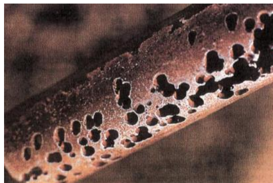
Foto 8: Tubo de aluminio picado por unas bacterias sulfatorreductoras debajo de una capa de babazas
