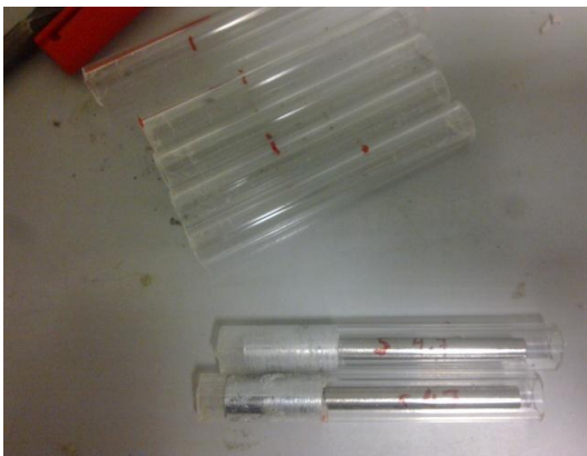
Fotos 34, 35, 36 y 37: Diversas fases de la fabricación de los electrodos. Fuente: Jose Manuel Gandía Romero.
