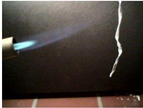
Foto 12: Residuo combustión, Óxido de Magnesio.
