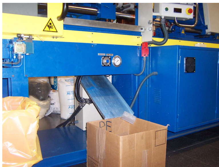
Fig. 6.11: Pieza saliendo de la máquina inyectora
