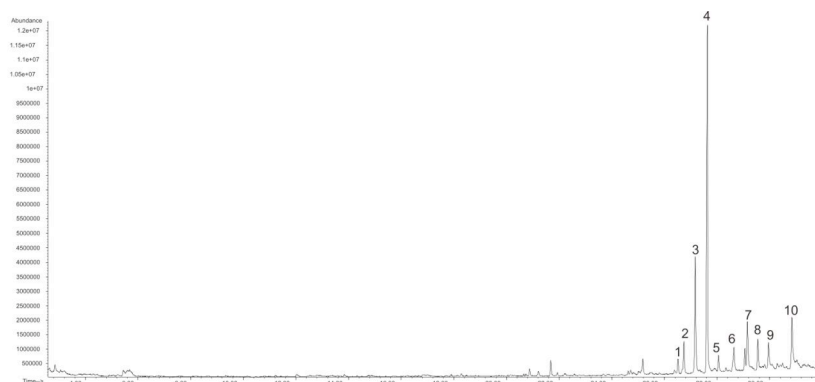
Figura 114 – Pirograma de la muestra de la resina de pino, mezclada con pigmento negro de manganeso (Rr Pi UV 4), envejecida por irradiación de luz UV.
