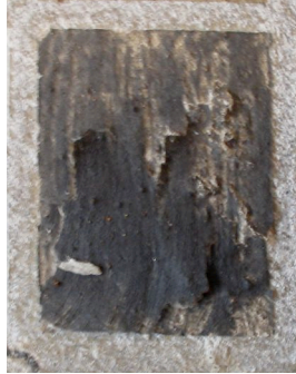
Figura 125 - Detalle de la probeta M4 después de 168 horas en la cámara de SO 2 .
