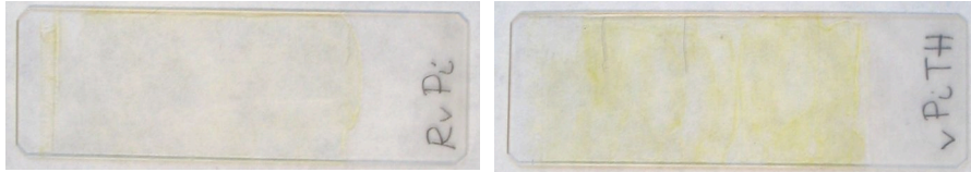
Figura 109 - Probetas realizadas con resina de pino en vidrio porta objetos sin envejecer (RvPi) y envejecida por TH (vPiTH).
