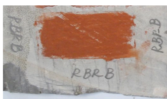
Figura 167 - Probetas realizadas con bastón, pigmento rojo óxido de hierro, aplicado a seco sobre piedra brasileña, antes (RBRB) y después de envejecidas por SO 2 (BRBSO).
