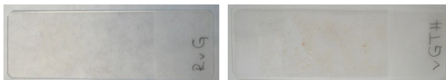
Figura 117 - Probetas realizadas con goma arábica en vidrio porta objetos sin envejecer (RvG) y envejecida por TH (vGTH).
