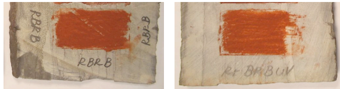
Figura 165 - Probetas realizadas con bastón, pigmento rojo óxido de hierro, aplicado a seco sobre piedra brasileña, antes (RBRB) y después de envejecidas por UV (BRBUV).
