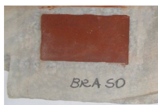
Figura 162 - Probetas realizadas con agua sobre piedra brasileña, antes (RBRA) y después de envejecidas por SO 2 (BRASO).
