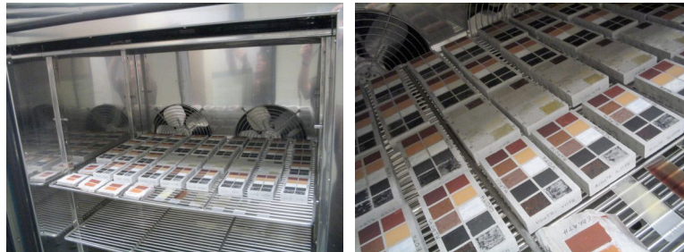
Figura 56 - Probetas en la cámara de envejecimiento acelerado térmico y por humedad.
