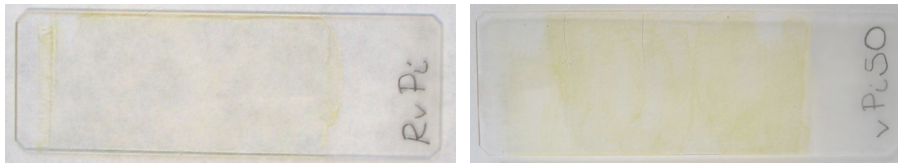
Figura 111 - Probetas realizadas con resina de pino en vidrio porta objetos sin envejecer (RvPi) y envejecida por SO 2 (vPiSO).
