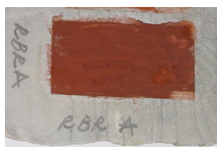
Figura 162 - Probetas realizadas con agua sobre piedra brasileña, antes (RBRA) y después de envejecidas por SO 2 (BRASO).
