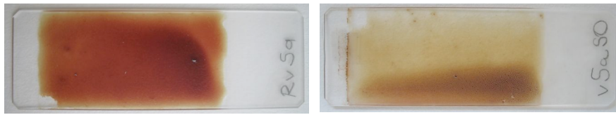
Figura 143 - Probetas realizadas con sangre en vidrio porta objetos sin envejecer (RvSa) y envejecida por SO 2 (vSaSO).
