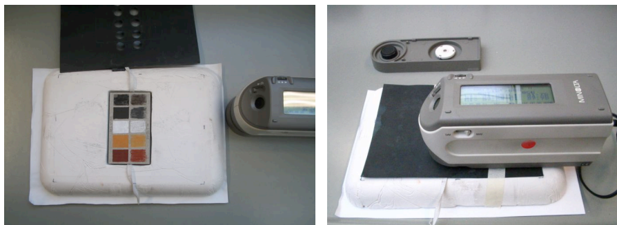
Figura 54 - Soporte en escayola para las mediciones de color.
