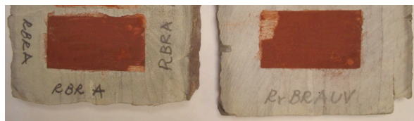
Figura 160 - Probetas realizadas con agua y pigmento rojo óxido de hierro sobre piedra brasileña, antes (RBRA) y después de envejecidas por UV (BRAUV).
