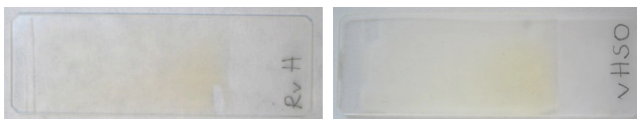
Figura 133 - Probetas realizadas con huevo en vidrio porta objetos sin envejecer (RvH) y envejecida por SO 2 (vHSO).
