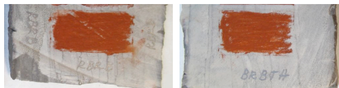
Figura 166 - Probetas realizadas con bastón, pigmento rojo óxido de hierro, aplicado a seco sobre piedra brasileña, antes (RBRB) y después de envejecidas por TH (BRBTH).
