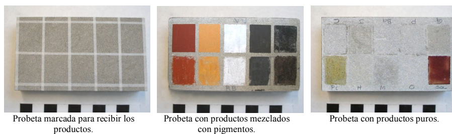
Figura 59 - Preparación de las probetas.
