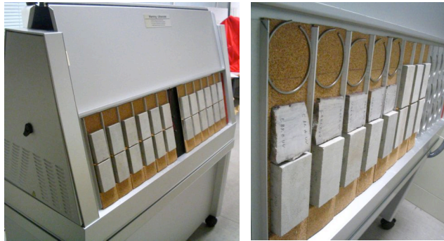
Figura 55 - Probetas en la cámara de envejecimiento por irradiación por luz UV.
