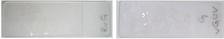
Figura 115 - Probetas realizadas con Goma Arábica en vidrio porta objetos sin envejecer (RvG) y envejecida por UV (vGUV).
