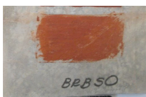
Figura 167 - Probetas realizadas con bastón, pigmento rojo óxido de hierro, aplicado a seco sobre piedra brasileña, antes (RBRB) y después de envejecidas por SO 2 (BRBSO).
