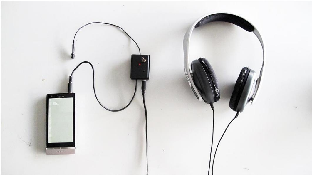
*Ilustración 16: Dispositivo móvil con amplificador y sensor de campos electromagnéticos conectado a los auriculares.*
