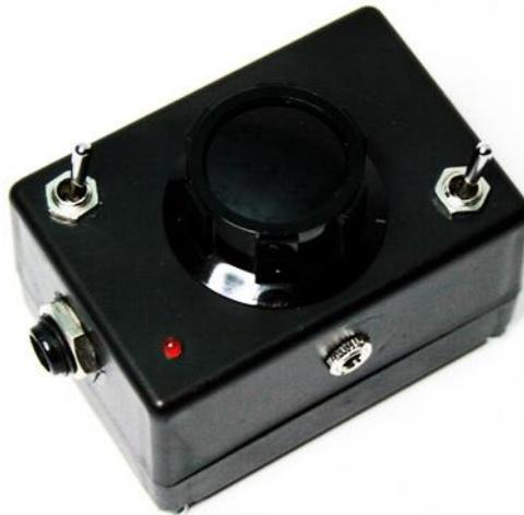
*Ilustración 37: Amplificador creado por Víctor Mazón con dos potenciómetros, uno regulable y otro de dos posiciones con entrada para diferentes sensores y salida de auriculares.*
