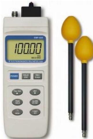
*Ilustración 5: Medidor de campo electromagnético con amplio rango de medida entre 100kHz a 3GHz, con antenas triaxiales e isotrópicas.*
