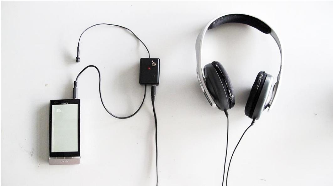
*Ilustración 36: Dispositivo móvil con amplificador y sensor de campos electromagnéticos conectado a los auriculares.*
