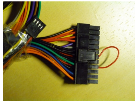
(Fig. 67) Fuente de alimentación de ordenador (Fig. 68) Puenteadado de la manguera
