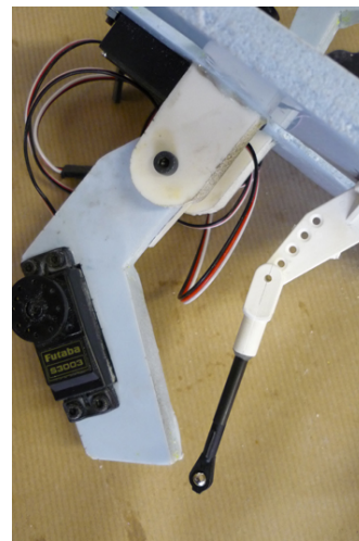
(Fig. 48) Montaje de las piezas en PU (Fig. 49) Colocación de la varilla con rótula para la mandíbula
