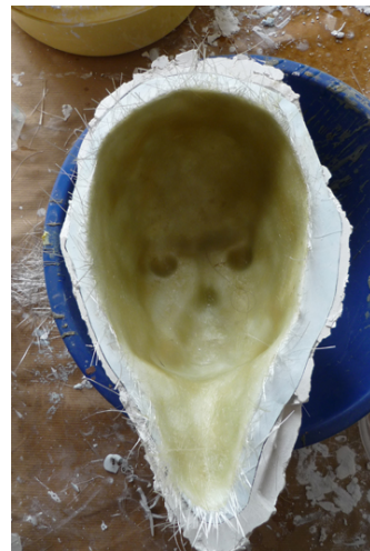
(Fig. 45) Réplica de resina de poliéster y fibra de vidrio
