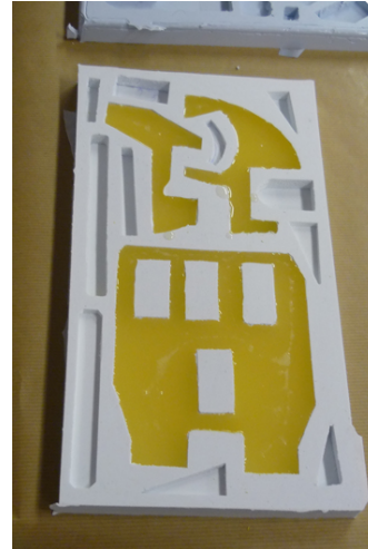
(Fig. 46) Piezas en cartón-pluma (Fig. 47) Molde de silicona y colada de PU
