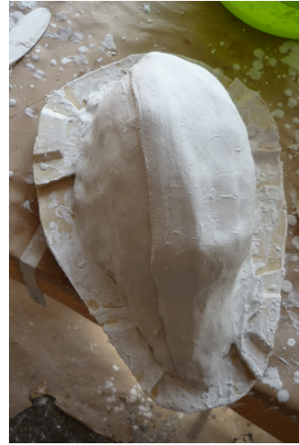
(Fig. 42) Aplicación de silicona tixotropada (Fig. 43) Caja madre en venda de escayola
