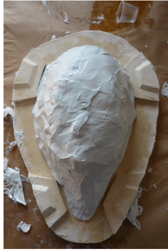
(Fig. 42) Aplicación de silicona tixotropada (Fig. 43) Caja madre en venda de escayola
