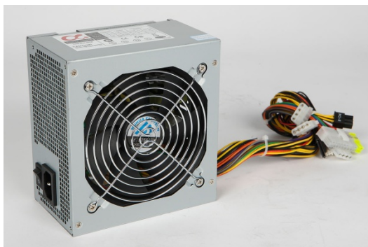
(Fig. 67) Fuente de alimentación de ordenador (Fig. 68) Puenteadado de la manguera
