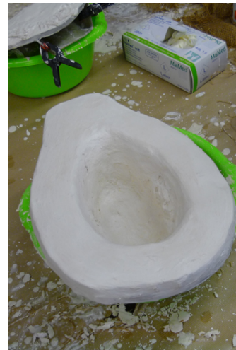
(Fig. 40) Calibrado del grosor con barro (Fig. 41) Contramolde de escayola con arpillera
