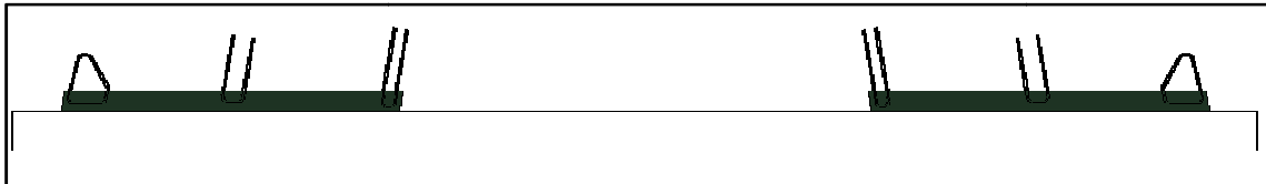
Figura 26. Fase 1: hormigonado laterales
