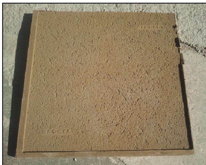
Figura 52. Prueba de textura final antideslizante
