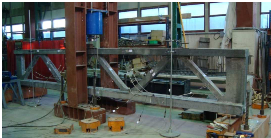
Figura 20. Modelo reducido de celosía de HMAR en laboratorio
