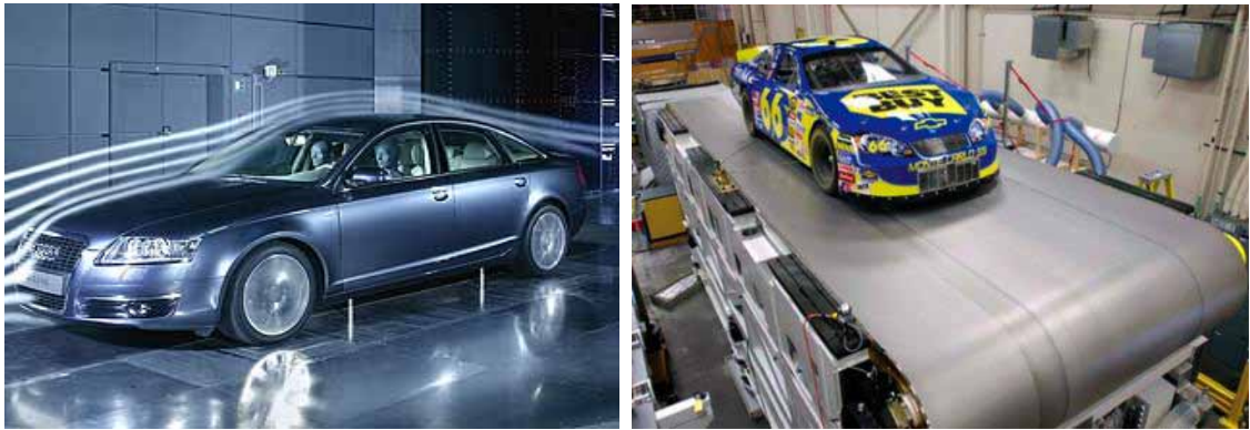
Ilustración 6 - Túnel de Viento de Audi, y preparación de una banda de suelo rodante. 11
