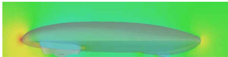
Ilustración 17 - Punto de estancamiento en el vehículo del IDF. 25
