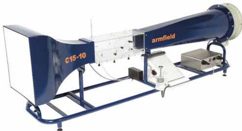
Ilustración 5 - Túnel de Viento 10
