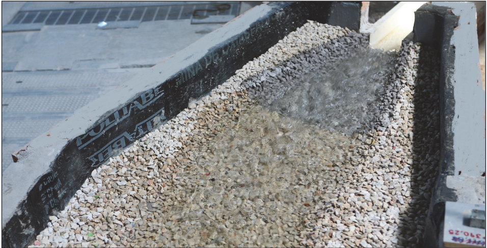
Figura 3. Vista del modelo físico. Cuenco de amortiguamiento. Q=98 \text{ m}^3/\text{s}
