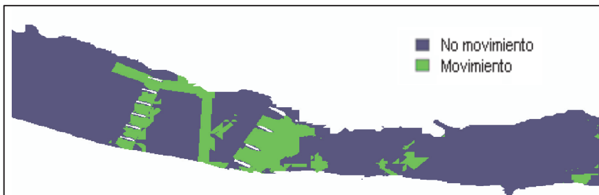
Figura 1. Mapa de movimiento - no movimiento. Detalle en la zona de dos de los puentes del cauce
