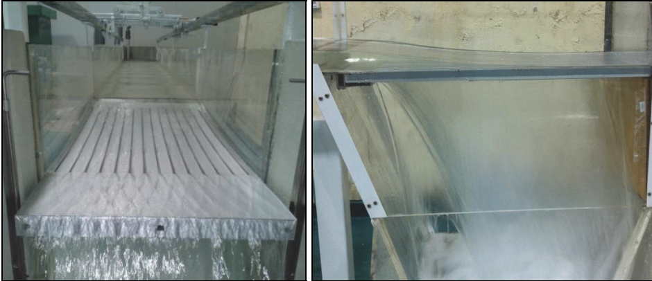
Figura 2. Detalle del flujo a su paso por la reja
