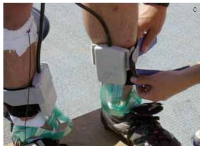
Figura 4. (A) Plantillas instrumentadas; (B) Detalle de la colocación de la plantilla en el calzado; (C) Detalle de la fijación del equipo de medida al tobillo.
