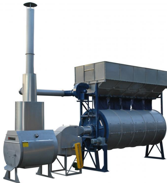
Figura 2. Secador rotativo utilizado na secagem do feijão carioca.
