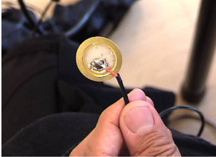
Fig. 64. El “Pienzo”, sensor usado en el experimento “TornadoDance” (2003), de Ludmila Pimentel
