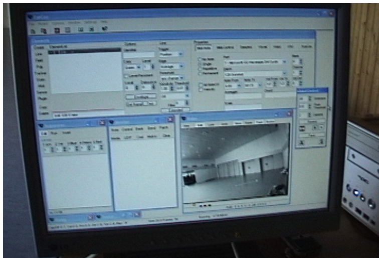
Fig. 81. Cinco componentes de la plataforma del software : “Elementos”, “Video”, “Monitor”, “Secuenciador” y los “Controles generales”
