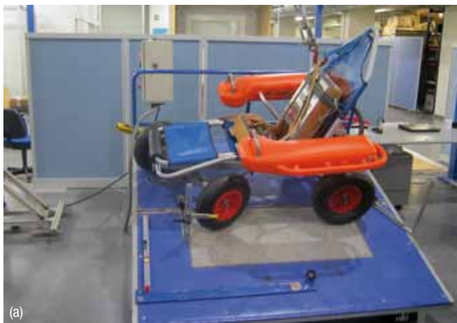
Figura 5. Detalle de los ensayos: a) Estabilidad lateral; b) Tracción del reposabrazos.
