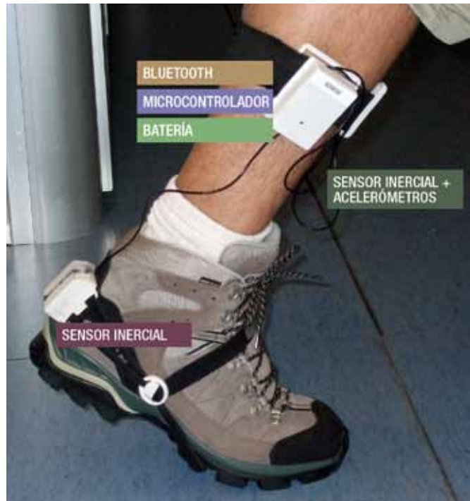
Figura 4. Sistema de registro del patrón biomecánico de carrera en tienda.
