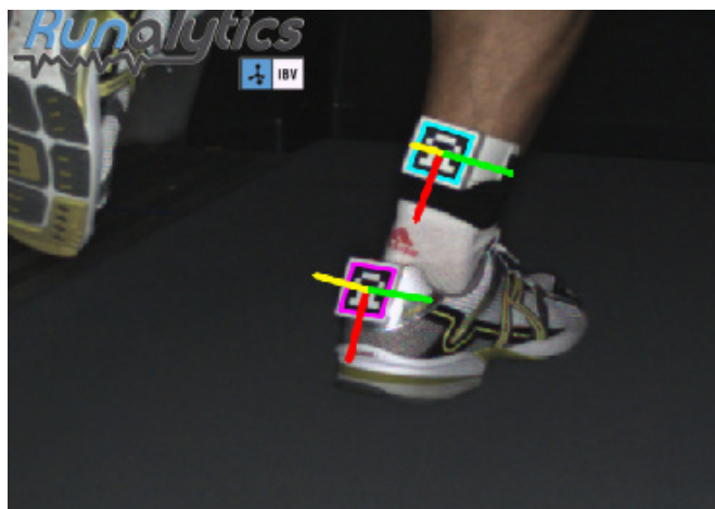
Figura 2. Corredor instrumentado con marcadores planos.
