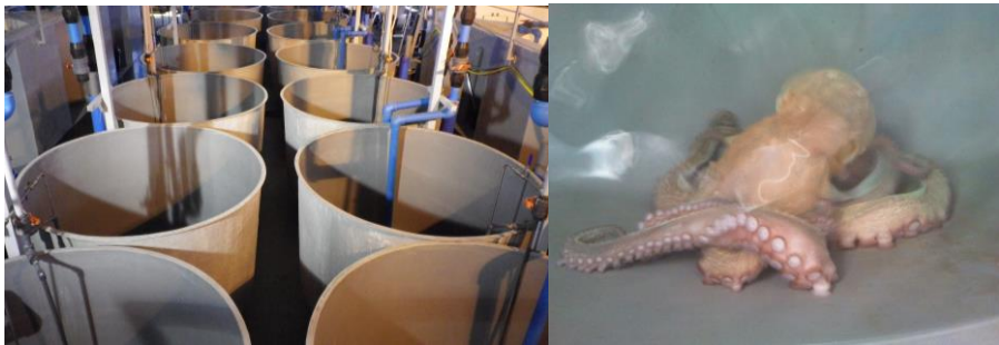
Figura 18. Detalle del sistema de Tanques individuales.
