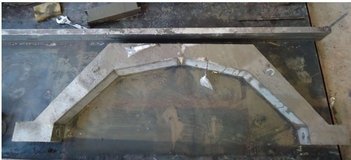
Figura 8.29. Vista del elemento construido tras el desencofrado.
