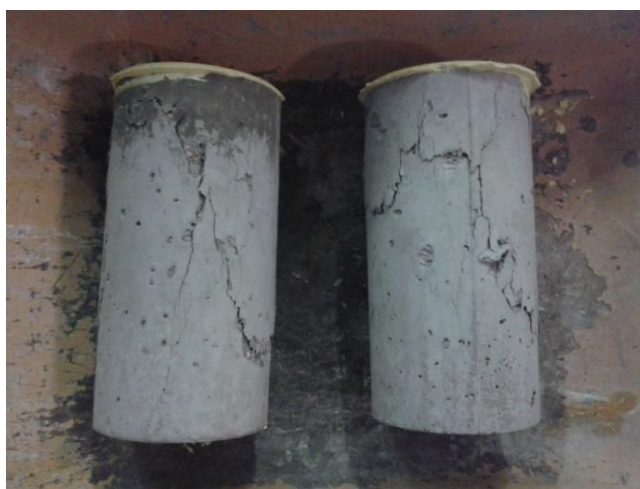
Figura 5.6. Rotura a siete días de las probetas de la primera amasada.
