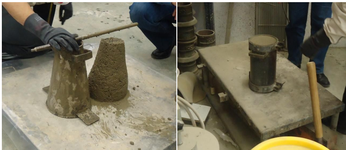
Figura 5.4. a) Ensayo del cono de Abrams realizado en la primera amasada; b) Mesa vibrante.
