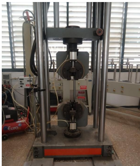
Figura 5.18. Máquina utilizada para realizar el ensayo de tracción en las barras de acero.
