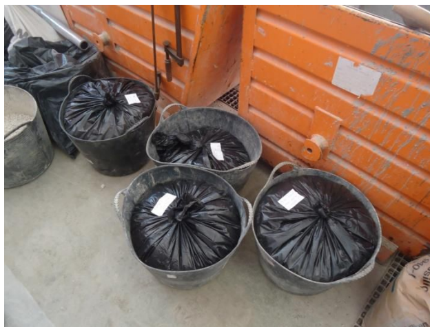
Figura 5.10. Separación de los áridos en bolsas para mantener su humedad.
