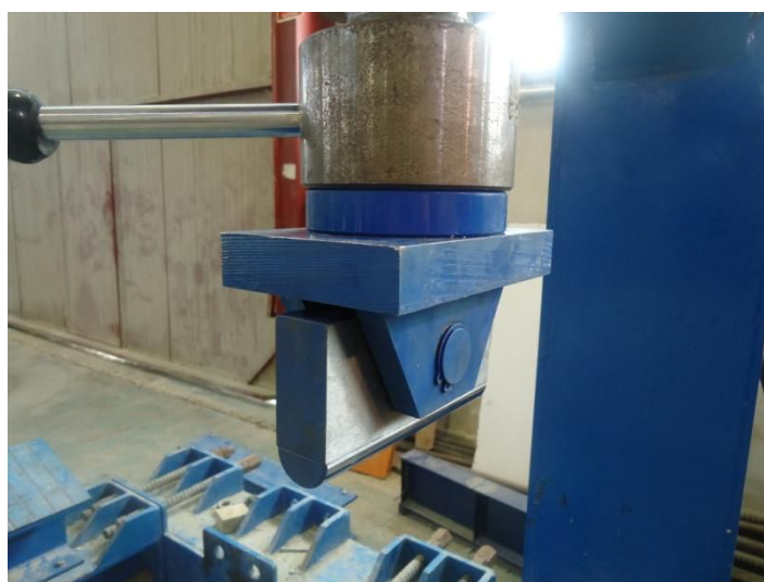
Figura 9.3. Rótula de carga fijada al accionador hidráulico.
