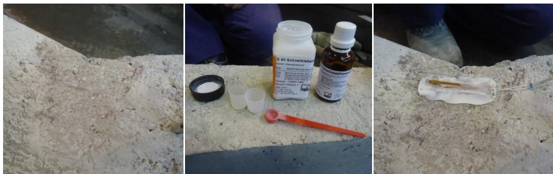
Figura 9.2. Imágenes del proceso de colocación de las galgas extensiométricas en hormigón.
