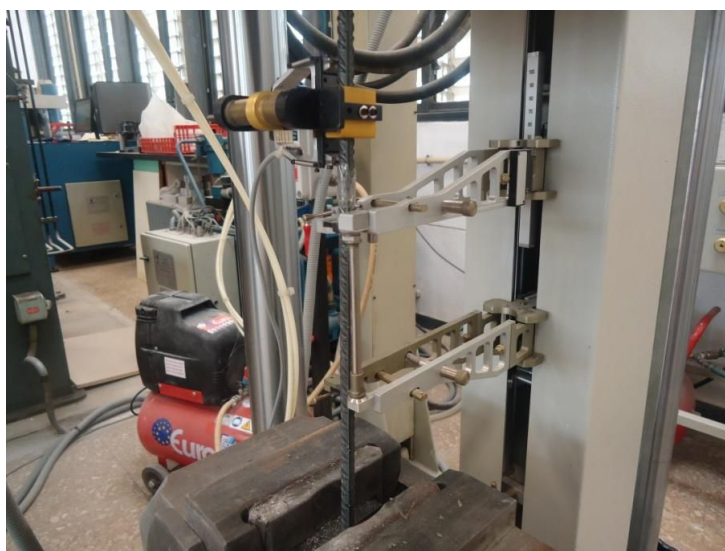
Figura 5.20. Probeta de ensayo en la cual se han colocado los captadores de 50 y 100 mm.
