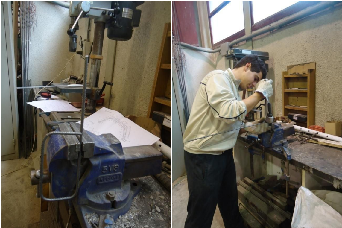
Figura 8.8. a) Uso del gato para el agarre de las barras; b) Doblado de las barras de los cercos.
