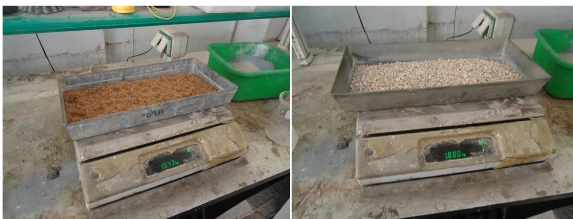
Figura 5.1. a) Pesaje de la bandeja de arena húmeda; b) Pesaje de la bandeja de grava húmeda.
