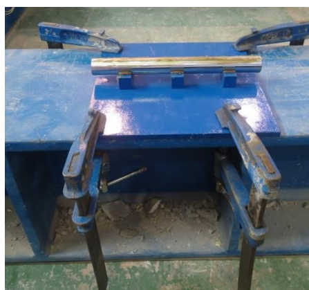
Figura 9.4. Aparato de apoyo deslizable fijado en el pórtico de carga.
