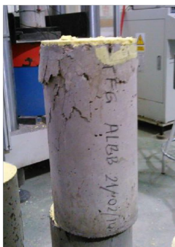
Figura 5.8. Probeta de la segunda amasada tras el ensayo de compresión a 28 días.
