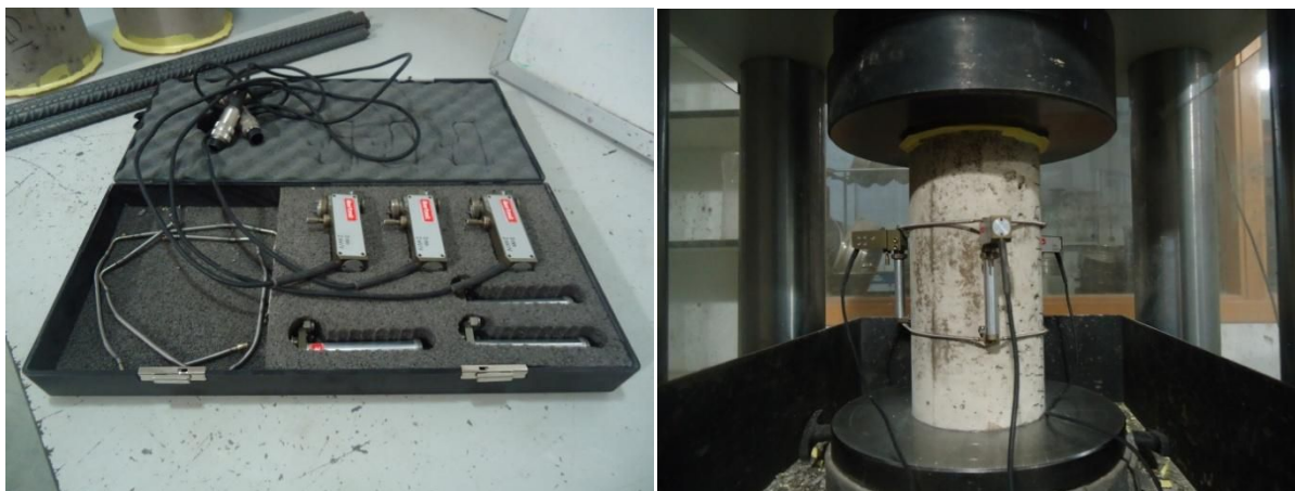
Figura 5.9. a) Sistema de tres extensómetros para la determinación del módulo de Young estático a compresión del fabricante Ibertest; b) Instalación del equipo de medida del módulo de Young en la probeta.
