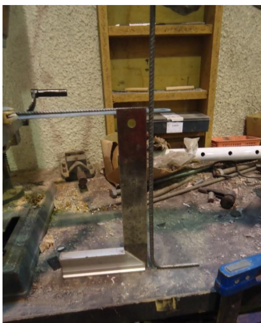
Figura 8.7. Verificación de la perpendicularidad de los tramos rectos contiguos del cerco mediante la comparación con una escuadra.
