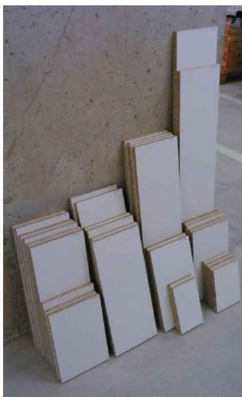
Figura 7.3. Listones de madera para construir el encofrado.
