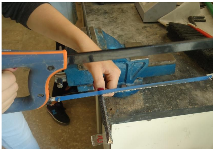
Figura 5.19. Preparación de la probeta para el ensayo de tracción.
