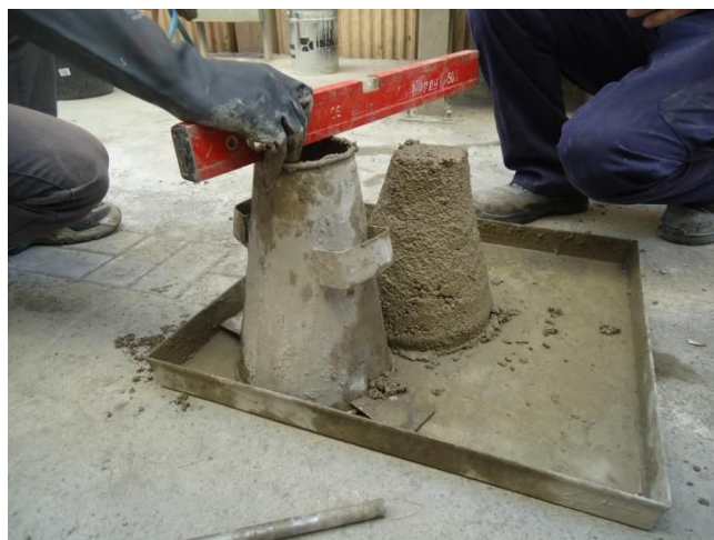
Figura 5.12. Asentamiento del hormigón del elemento medido mediante el cono de Abrams.
