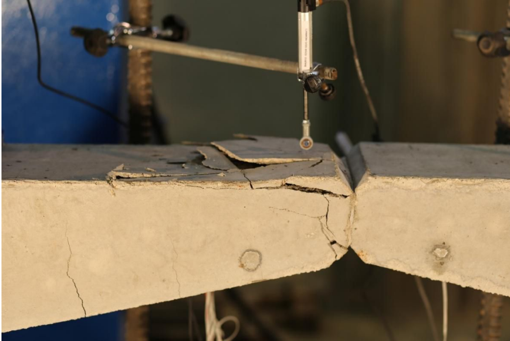
Figura 10.10. Vista de la zona de rotura.
