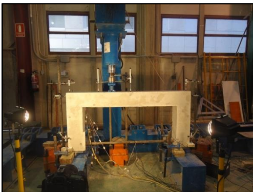
Fig 4.5.1 Colocación del elemento en el pórtico de ensayo
