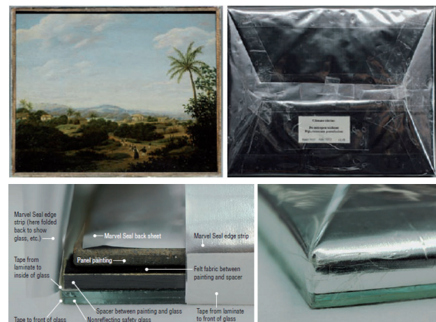
f.35. Creación de microclimas con Marvelseal®. 75
