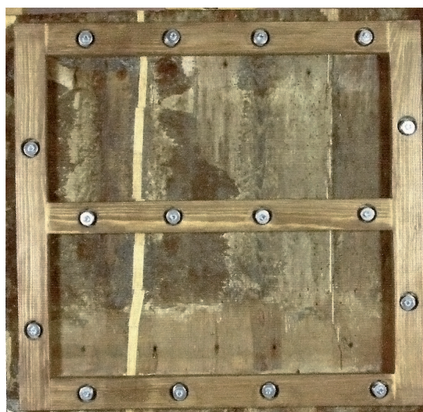
f.20. Bastidor perimetral con muelles cónicos. 43
