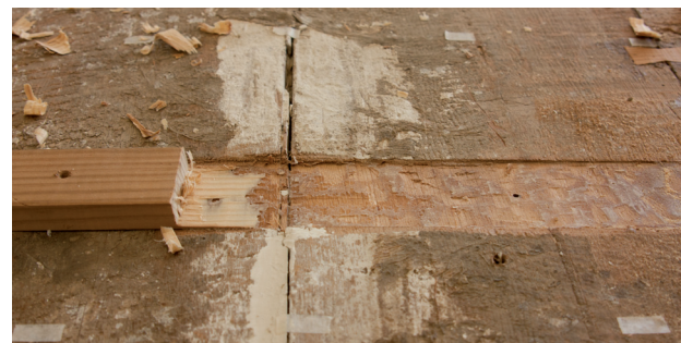
f.39. Rebaje del soporte original para la colocación de los travesaños
