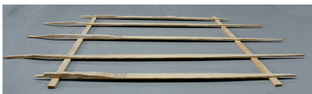
f.89. Encolado de los listones flexibles a los travesaños verticales fijos.
