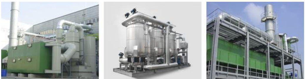
Figura 1.10: Instalación de adsorción en carbono.
