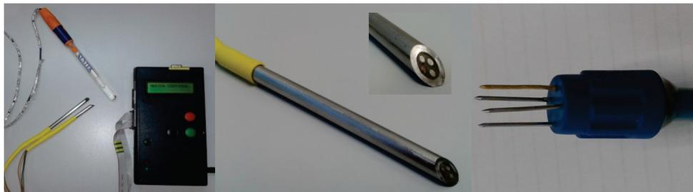
**Figura 13. Equipo potenciométrico (izquierda), multielectrodo con forma de “cala” (centro), multielectrodo en forma de corona (derecha).**
