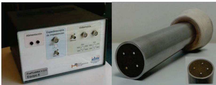
**Figura 15.** Equipo voltamétrico (izquierda) y multielectrodo (derecha).
