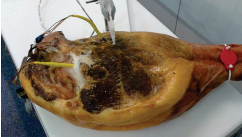
**Figura 14. Obtención de medidas potenciométricas sobre jamón curado.**
