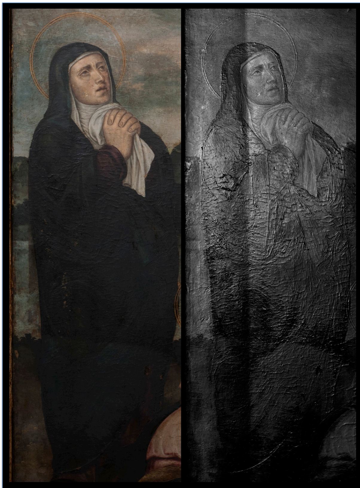
Fig. 35 Capturas de detalle de la pintura sobre tabla El Calvario enfatizando la textura que denota deterioro en la capa pictórica. Sin filtro (izquierda) y con filtro especular (derecha).
