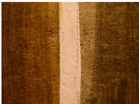
Fotografía macro donde se aprecia el temple de huevo recién aplicado sobre la pintura al fresco de color sombra natural (izquierda) y detalle de separación entre dos probetas cubiertas con temple de huevo
