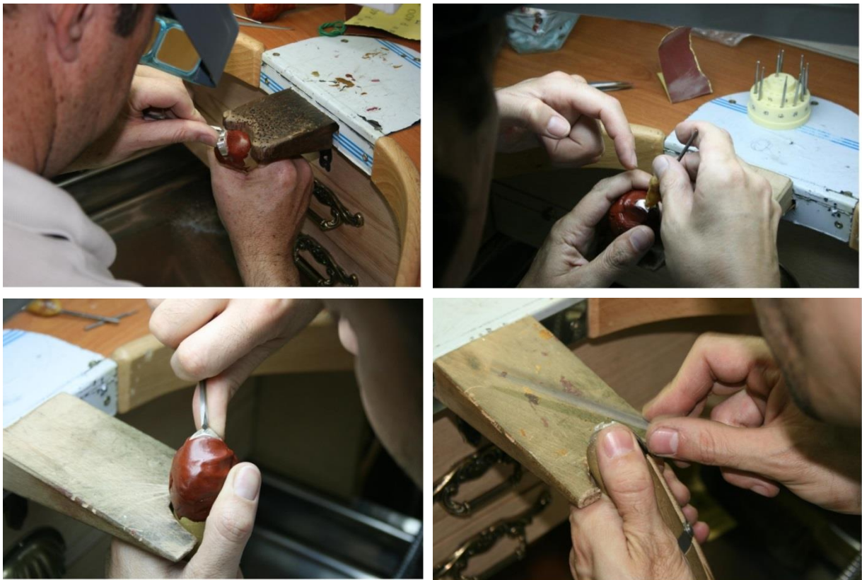
(Imagen XXIV, XXV, XXVI,) Proceso de engastado de gemas. (Imagen XXVII) Modelado manual de cera.
