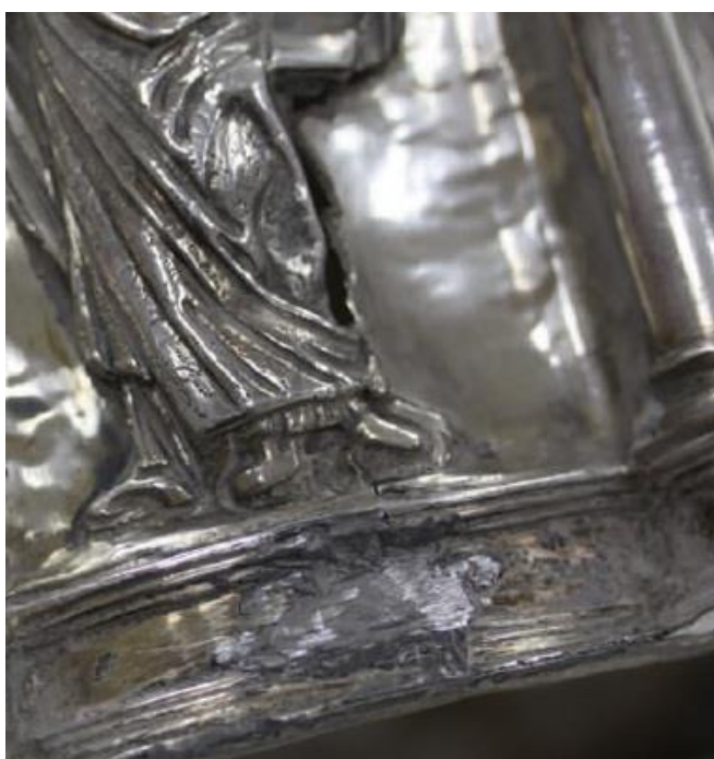
(Imagen XX y XXI) Ejemplo de soldaduras de estaño. Cruz procesional Parroquia santa María Magdalena .Tibi
