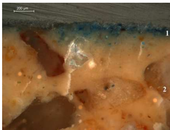
Fig. 4. Sección transversal donde se identifican la capa pictórica de azul egipcio, y la capa preparatoria de cuarzo y feldespato cementados con calcita. Fuente: Doménech Carbó M. T.: "Informe Analítico".
