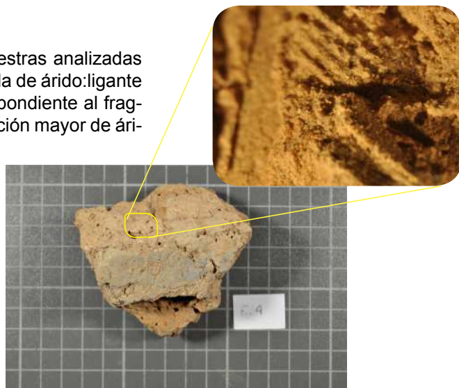
Fig. 2. a. Fotografía al microscopio óptico 1.3x; b. Fotografía del fragmento E-4. (CALABRIA, 2013).
