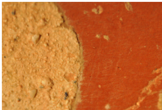
Fig. 8. Fotografía al microscopio del detalle de capa pictórica blanca realizada con la técnica del Fresco Secco . Fragmento E-6, 1.3x. (CALABRIA, 2013).
